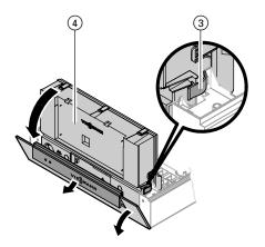
**6.** Verschlussbügel ③ lösen und Regelung ④ nach unten klappen.
