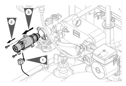
Heizkessel in umgekehrter Reihenfolge wieder zusammenbauen. Anzugsdrehmoment Befestigungsschrauben 4 Nm.
