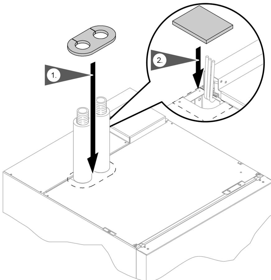
1. Schutzfolie von der Unterseite der Dämm-Matte abziehen, die Dämm-Matte über die Soleanschlüsse streifen und auf den Oberblechen fest andrücken.
