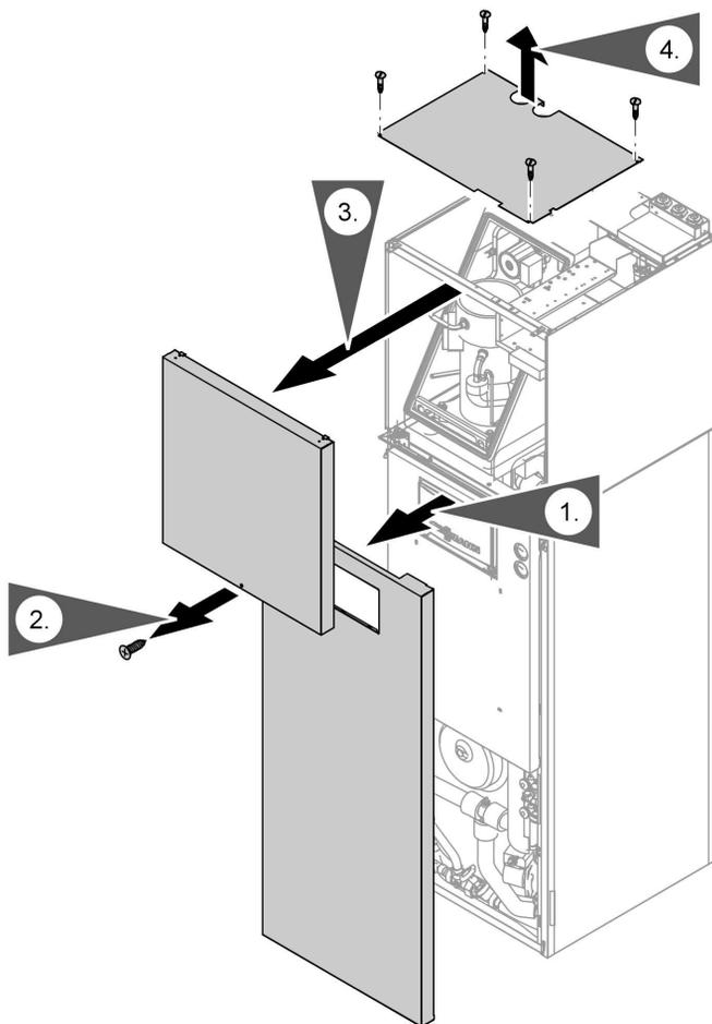
1. Unteres Vorderblech an der Oberkante nach vorn herausziehen und nach oben herausheben.
