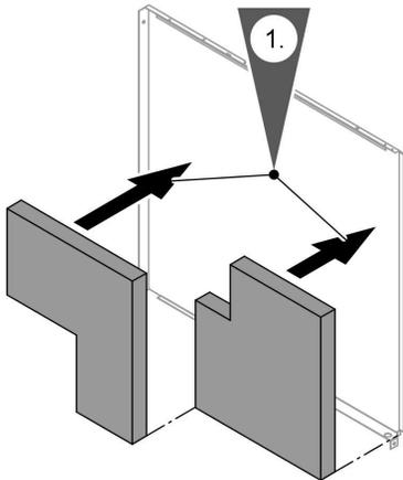
1. Rechtes Seitenblech gemäß nebenstehender Abbildung mit selbstklebenden Schalldämm-Matten versehen.
