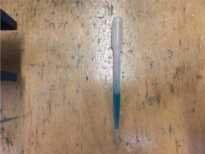
Kühlmittelprobe mit Hilfe einer Pipette aufnehmen
