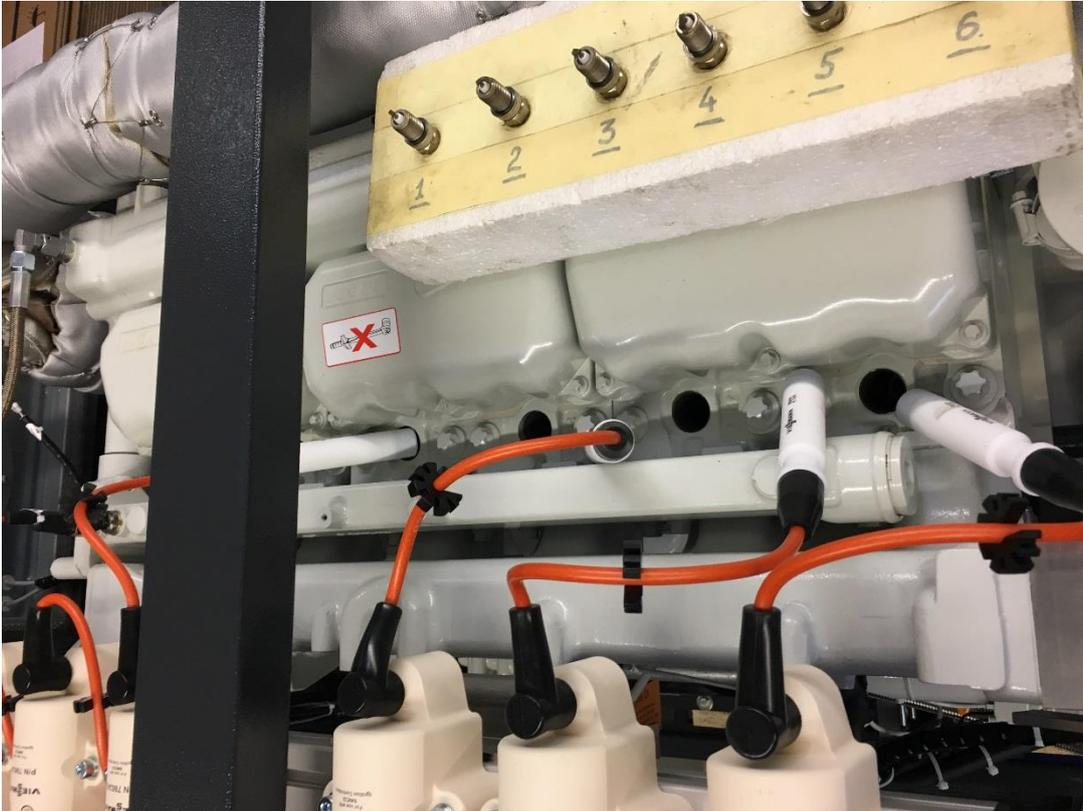
3. Motor durchdrehen und in jeden Zylinder Konservierung sprühen (ca. 2-3 sec lang), Motor langsam durchdrehen und nochmals sprühen
