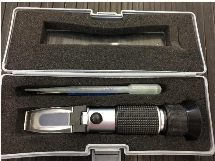
5. Frostschutzkonzentration vom Kühlwasser prüfen (-27/38°C) ggf. auffüllen (Refraktometer nutzen)
