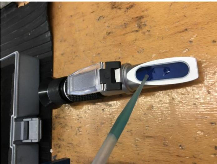
Kühlmittelprobe auf das blaue Prisma des Refraktometers tropfen lassen
