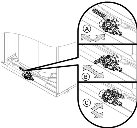
(C) Entleerung Trinkwasserkreislauf im Gerät **ein-schließlich** Speicher-Wassererwärmer über den Warmwasseranschluss. Der Kaltwasseranschluss bleibt gefüllt.
