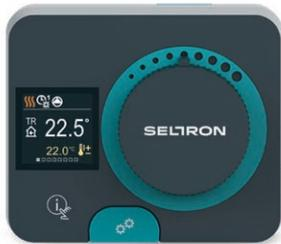
Der AHD20 ist ein kompakter, witterungsgeführter Heizungsregler, der in das Stellantriebgehäuse eingebaut ist. Er wird für die Steuerung des Mischventils und der Umwälzpumpe zur Regelung der Vorlauftemperatur beim Heizen oder Kühlen in Abhängigkeit von der Außentemperatur, verwendet.
