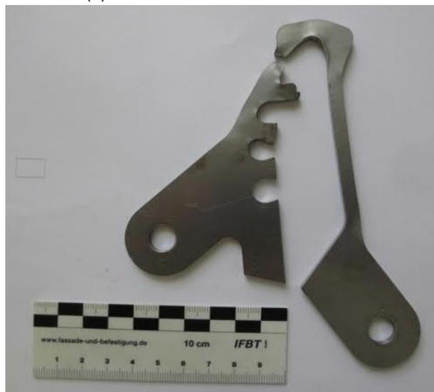
Probekörper nach dem Bruch
