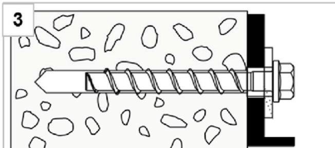
3 Einbauzustand ohne verfüllten Ringspalt
