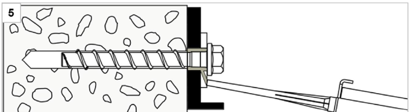
5 Verfüllung des Ringspalts mit chemischem Mörtel
