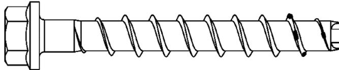
z.B. CELO Betonschraube, Ausführung mit Sechskantkopf und Anbauteil
