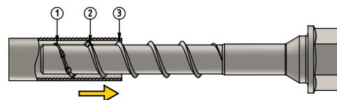
Die BTS M darf nur dann wiederverwendet werden, wenn max. 3 Gewindegänge in die Prüfhülse eindringen können.
