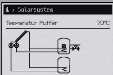
Die Sonne im Blick: Um die eingesparte Heizenergie zu veranschaulichen und die Funktion der Solaranlage kontrollierbar zu machen, zeigt die Systembedieneinheit Logamatic RC310 den Solarertrag und den aktuellen Betriebszustand Ihres Solarsystems an.
