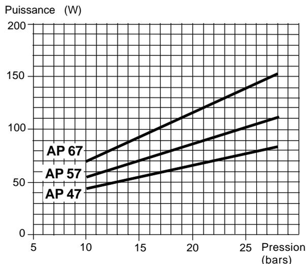
Viscosité = 5 cSt - Vitesse de rotation = 2850 t/min
