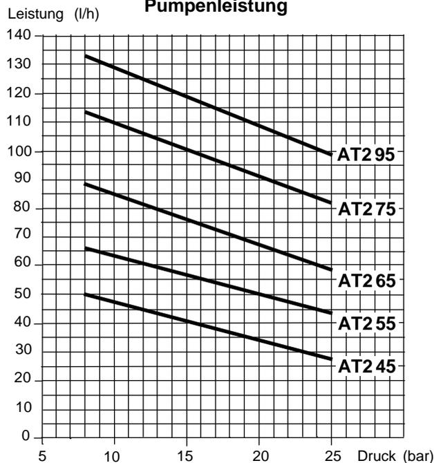
In den dargestellten Kurven ist bereits eine Abnutzung des Getriebes berücksichtigt.
