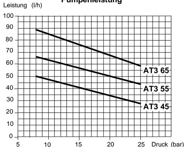
Viskosität = 5 cSt - Pumpendrehzahl = 2850 U/min
