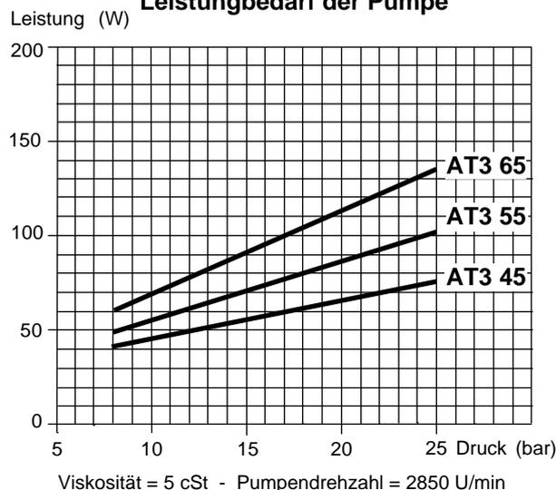
Viskosität = 5 cSt - Pumpendrehzahl = 2850 U/min
