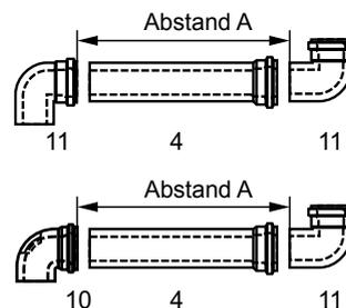
Abstand A bestimmen. Länge Luft-/Abgasrohr (4) immer ca. 100mm länger als Abstand A. Abgasrohr immer auf der glatten Seite kürzen, **nicht** auf Muffenseite.
