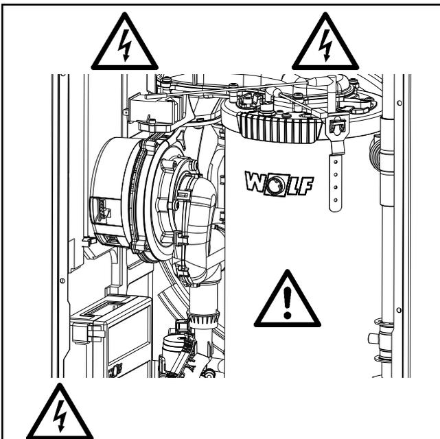
Bild: Zündtrafo, Hochspannungs-Zünderlektrode, Brennkammer
