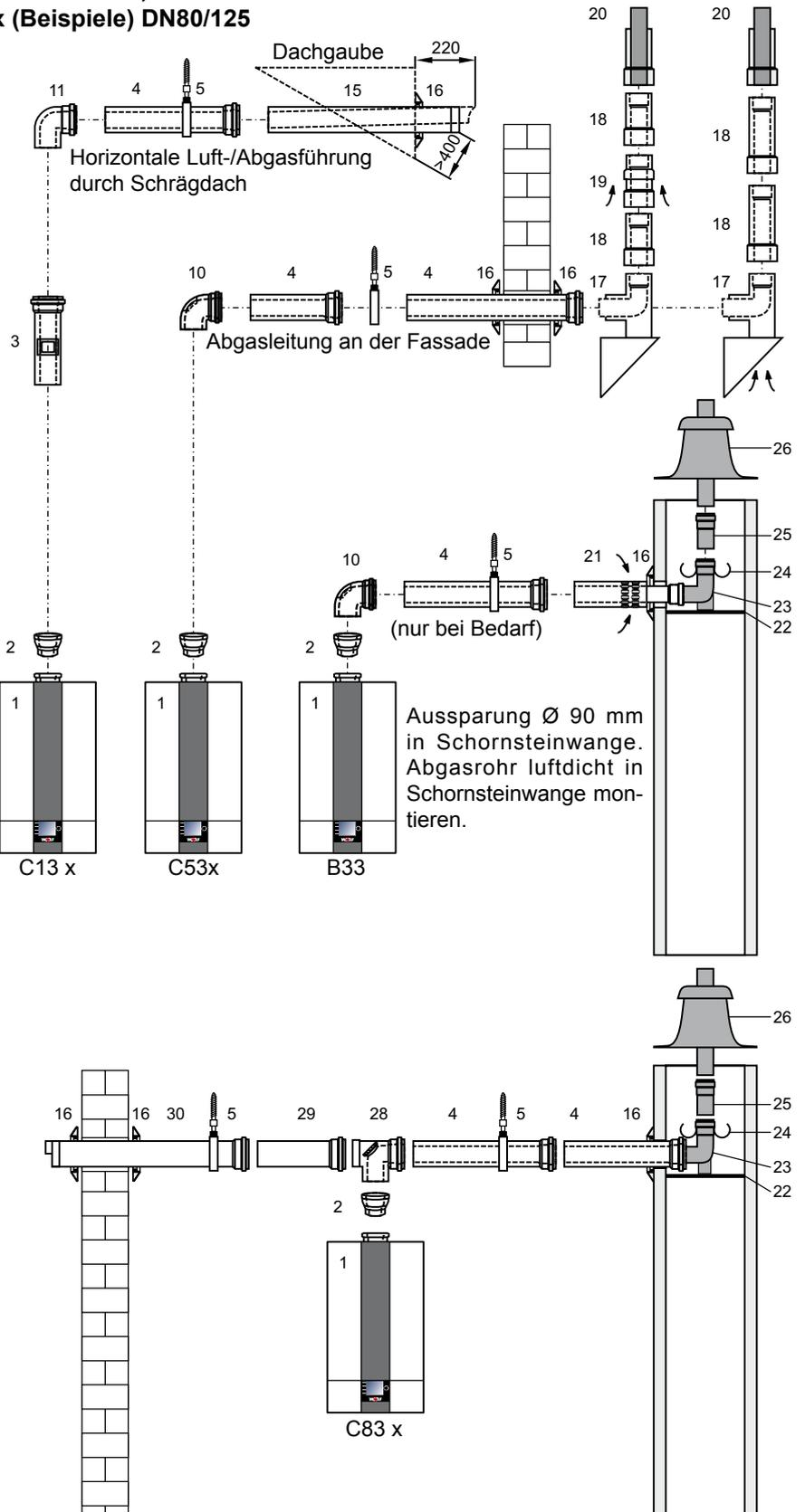
Die waagerechte Abgasführung ist mit ca. 3° Gefälle (6cm/m) zum Gerät zu montieren. Die waagerechte Luftführung ist mit ca. 3° Gefälle nach außen zu verlegen - Luftansaug mit Windschutz ausführen; zulässiger Winddruck am Lufteintritt 90 Pa, weil bei einem höheren Winddruck der Brenner nicht in Betrieb geht. Im Schacht kann nach dem Stützbogen (23) die Abgasleitung in DN80 verlegt werden. Eine flexible Abgasleitung DN83 kann nach dem Stützbogen (23) angeschlossen werden.
