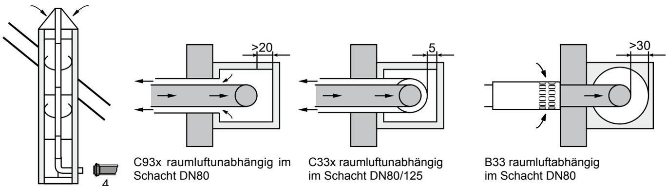
C93x raumluftunabhängig im Schacht DN80
