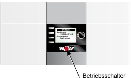
Das AM oder das BM-2 in den Steckplatz über dem Aus/Einschalter (WOLFlöge) aufstecken. Beide Module können in diesen Steckplatz eingesteckt werden. Weitere Maßnahmen für die Inbetriebnahme oder Adressierung speziell beim BM-2, entnehmen Sie der Montageanleitung BM-2.
