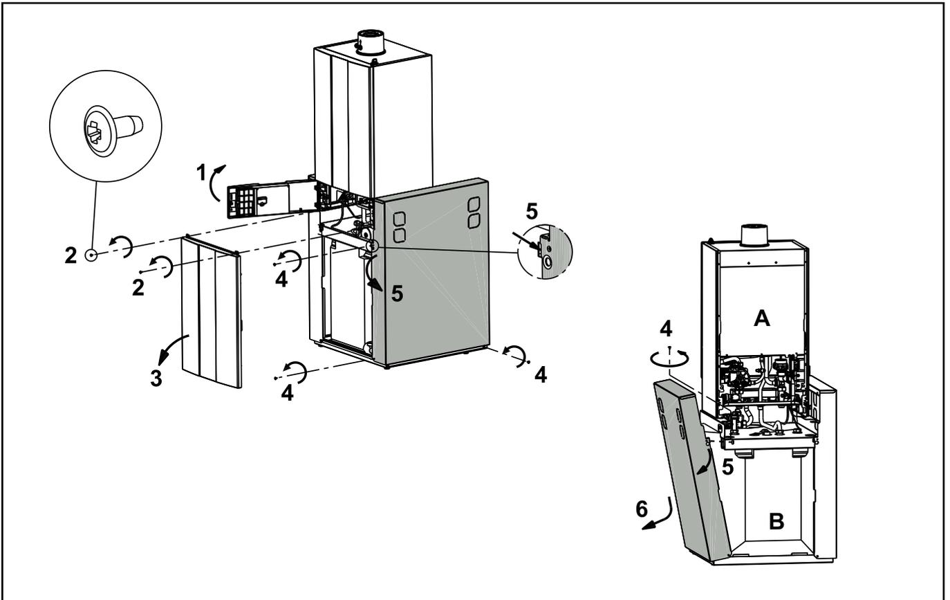
Bild: Demontage Seitenverkleidung Speicher CGS-2L/R
