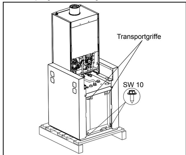
Bild: Transportgriffe / Sicherungsschrauben hinten
