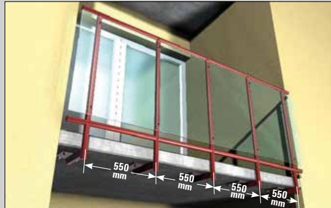
Der Einsatz von M10-Ankern ist wegen der geringen Betonplattendicke nicht möglich. Für die möglichen M8-Anker sind aber bereits 5 Ankerplatten/Pfosten und 20 Anker 8/10 A4 erforderlich.
