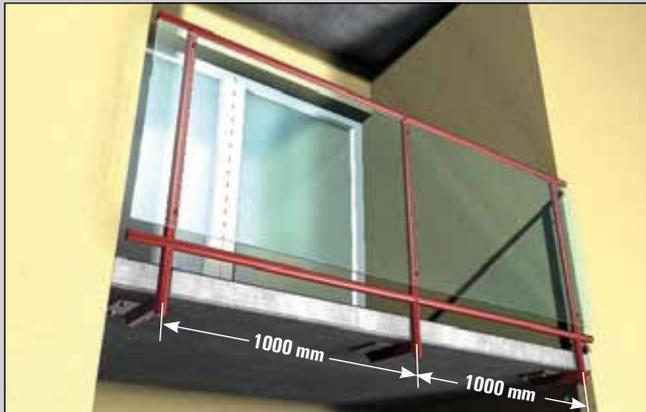
Durch die optimale Tragfähigkeit der K-Version kann ein Nachweis bereits mit 3 Ankerplatten / Pfosten geführt werden. Benötigt werden nur 12 Anker FAZ II 10/10 K A4.
