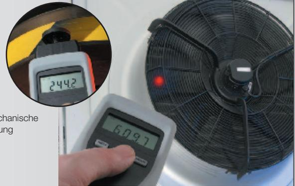
testo 470, mechanische Drehzahlmessung
