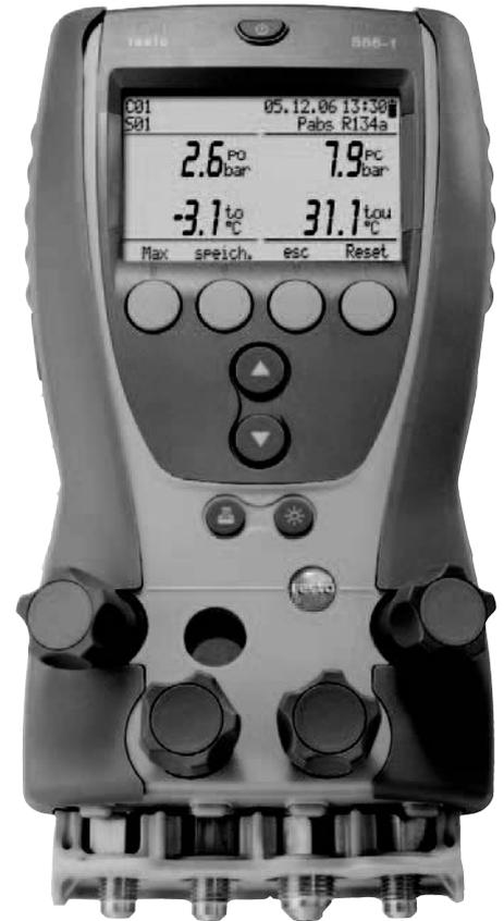
**testo 556-1, Elektronisches Kälteanlagen-Analysegerät, Anschlüsse aus Messing, inkl. Kalibrierprotokoll und Batterien**
