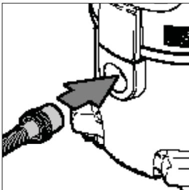
1. Saugschlauch am Sauger anschließen.
