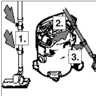
1. Saugrohrhalter am Saugrohr befestigen.
