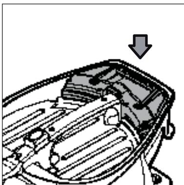
4. Batterie in den Sauger einsetzen und Batterie-Tragegriff zum Verriegeln der Batterie umklappen.
