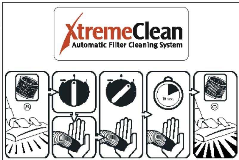
Um eine gleichbleibend hohe Saugleistung zu gewährleisten wird das Filterelement während des Betriebs automatisch abgereinigt. Bei extrem starker Verschmutzung des Filterelements empfehlen wir eine Vollabreinigung:
