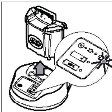
3. Nach Beendigung des Ladevorganges (Anzeige 100% leuchtet) die Batterie aus dem Batterie-Ladegerät entnehmen.
