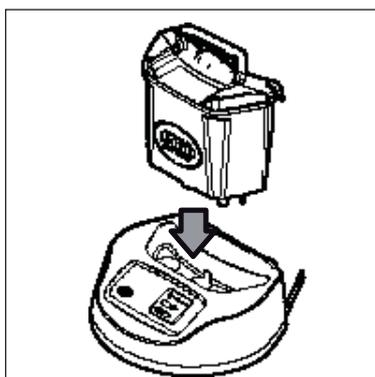
2. Batterie in das Ladegerät einsetzen.
