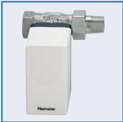
Der Proportional-Stellantrieb EMO 1 ist für den Anschluss an Temperaturregler mit stetigem Regelverhalten, z. B. HEIMEIER Thermostat E1, vorgesehen. Je nach verwendetem Ausgangssignal und Regelaufgabe stehen vier Ausführungen zur Verfügung: Steuerspannung 0–10 V; 10–0 V; 2–10 V; 10–2 V (Gleichspannung).
