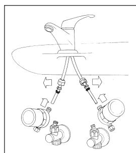
Inserire sui tubi di rame i raccordi rimossi precedentemente dai rubinetti d'intercettazione. Piegare leggermente entrambi i tubi verso l'esterno, per agevolare l'inserimento dell'ammortizzatore fino alla battuta interna di quest'ultimo.
