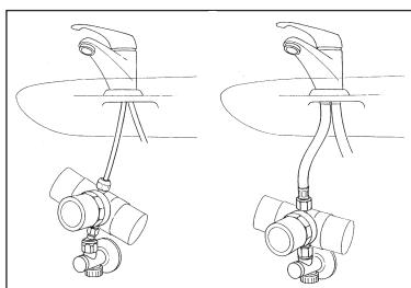
Gli attacchi disposti radialmente al pistone ammortizzatore consentono la rotazione dello stesso a seconda delle necessità di spazio.
