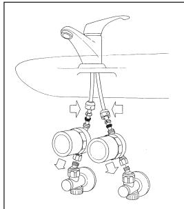
Piegare i tubi di rame verso l'interno, fino ad allineare l'attacco inferiore degli ammortizzatori con gli attacchi dei rubinetti d'intercettazione, quindi avvicinare e serrare sia la calotta mobile dell'ammortizzatore sui rubinetti che il raccordo superiore sul tubo del sanitario all'ammortizzatore.
