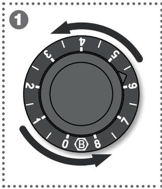
Ruotare la manopola in senso antiorario, fino al raggiungimento del punto "0" (fine corsa)
