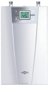
Elektronisch geregelter Durchlauferhitzer als Untertischgerät im Kompaktformat für die energieeffiziente Warmwasserversorgung einer Küchenspüle. Die Elektronik regelt die Leistungsaufnahme bis zur Leistungsgrenze, um die eingestellte Auslaufftemperatur gradgenau zu erreichen und konstant zu halten. Die Wunschtemperatur wird direkt am Tastenbedienfeld zwischen 20 °C und 60 °C eingestellt. Mit den beiden Programmtasten können zwei individuelle Temperaturen gespeichert und abgerufen werden.
