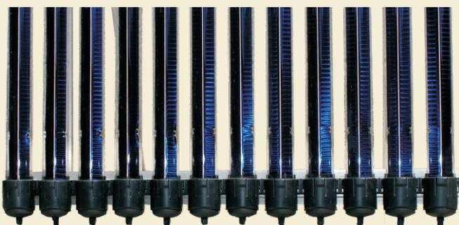
Des installations solaires à l'aide des collecteurs PR changent l'énergie du rayonnement solaire en chaleur utile. La chaleur produite dans les capteurs solaires est transportée à l'aide d'un fluide de travail vers le récipient d'eau utile ou industrielle, dont cette première est accumulée. Un régulateur différentiel de température qui coopère avec une pompe de circulation contrôle le travail effectif du système.
