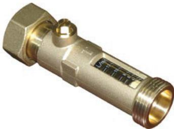
Durchflussmesser mit Außengewinden und Überwurfmutter an einem Endstück, von 3/4" bis 1 1/2", für thermische Solaranlagen, Heizungen und hydronische Systeme. Ablesung des Volumenstroms direkt über die Skala. Kugelhahn für Durchflussbegrenzung. Die sorgfältige Bemessung des Produkts sichert sehr geringe Ladeverluste.
