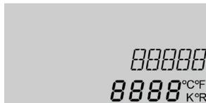
Die Kanalanzeige besteht aus 2 Zeilen. In der oberen 16-Segment-Anzeige werden hauptsächlich Kanalnamen/Menüpunkte eingeblendet. In der unteren 7-Segment-Anzeige werden Werte angezeigt.
