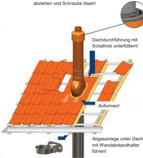
Abb.7: Schrägdach mit typischer Dachheizzentrale
