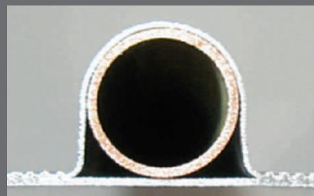
Durch die Omega-Ultraschall-Verschweißung vergrößert sich die Kontaktfläche für den Wärmeübergang.
