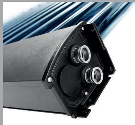
Flexibel beim hydraulischen Anschluss einer Kollektorreihe bis zu 7 SKR von einer Seite und wechselseitig bis zu 14 SKR.
