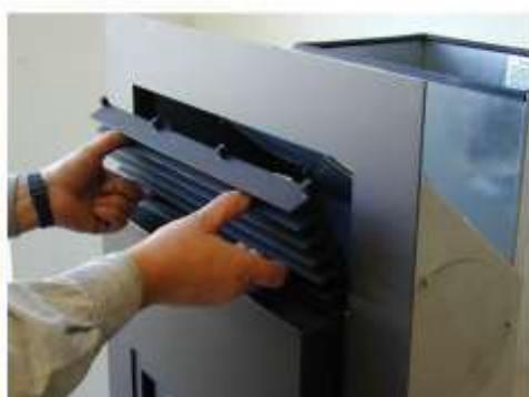
Frontgitter abschrauben und entfernen.
