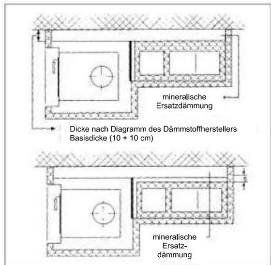
Wärmedämmung (Heizeinsatzbereich, keramische Züge)
