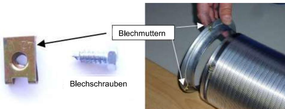
Blechmuttern seitlich auf Warmluftstutzen stecken. Stutzen in das Flexrohr stecken & mit Schlauchschelle im Flexrohr festziehen. Warmluftstutzen **von innen** mittels Blechschrauben über die vorher montierten Blechmuttern anschrauben. Frontgitter wieder einbauen.
