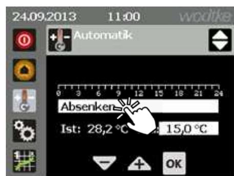
Abb. 19: Heizprogramm Permanent Absenken
