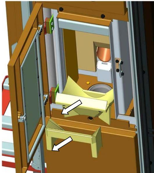
Abb. 95: Gussteile entnehmen
