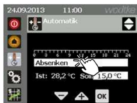
Abb. 20: Heizprogramm Frostschutz
