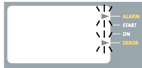
Abb. 12: ALARM und ERROR blinken
