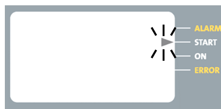
Abb. 13 Pfeil blinkt bei START
