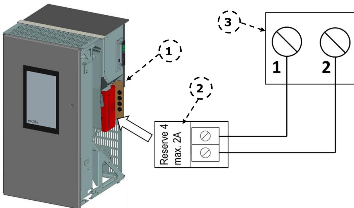
Abb. 11: Anschlusskizze wodtke Pellet Primärofen am DS 01 L
