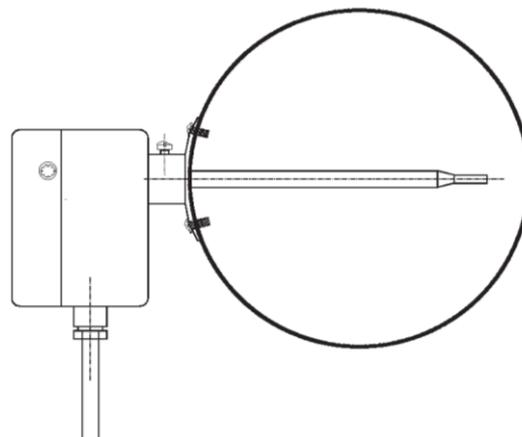
Abb. 8: Temperaturmessadapter montiert
