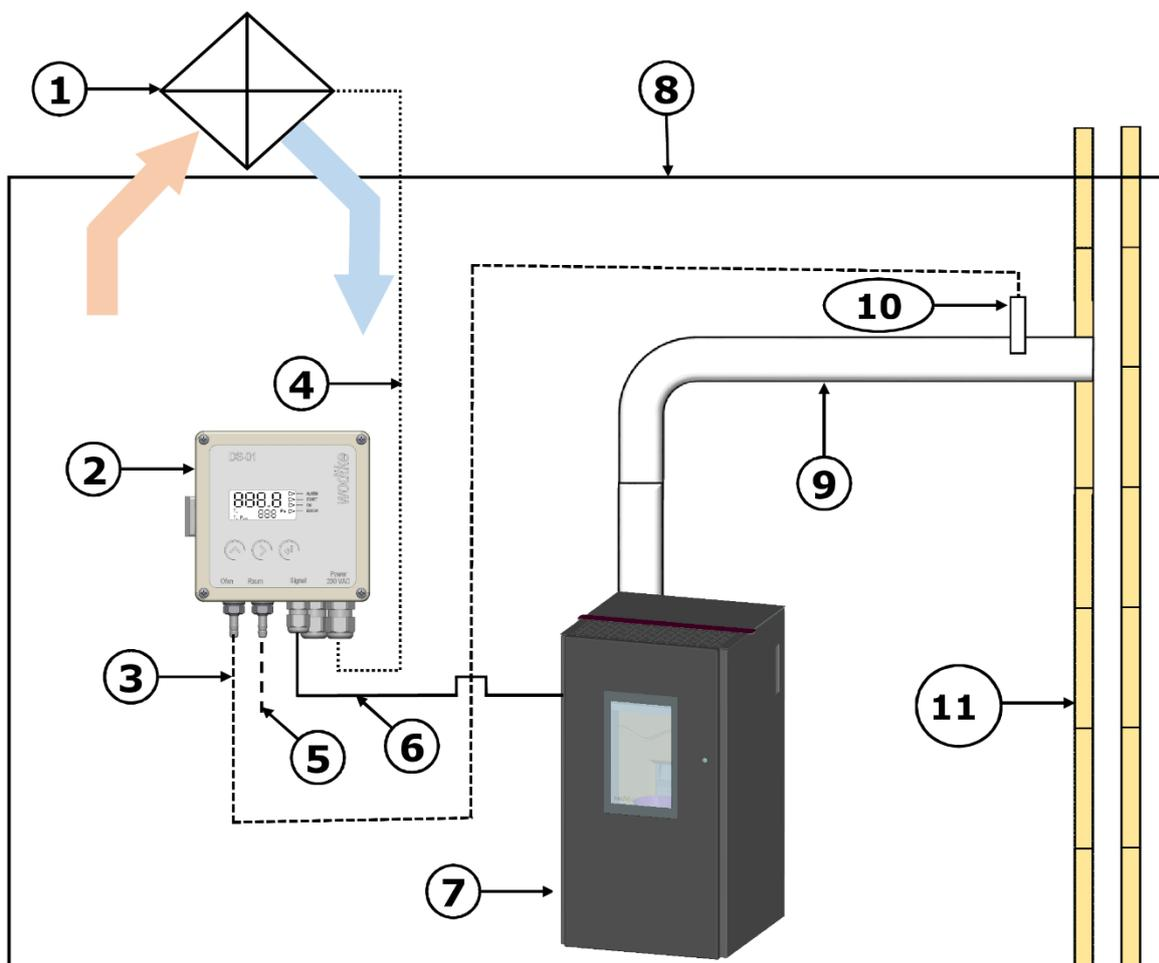
Abb. 3: Anschlusskizze DS 01 L mit wodtke Pellet Primärofen
