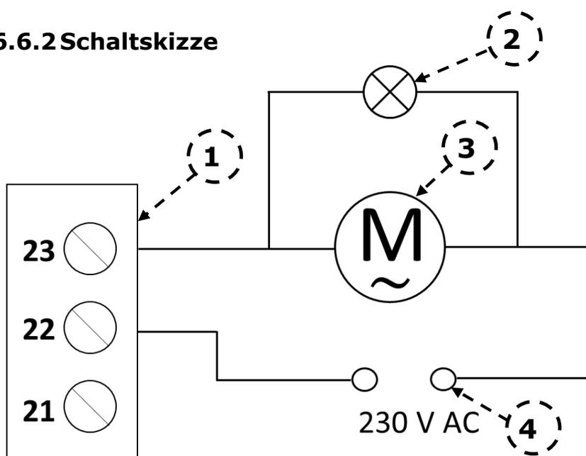
Abb. 13: Anschlusskizze DS 01 L mit Lüftungsanlage
