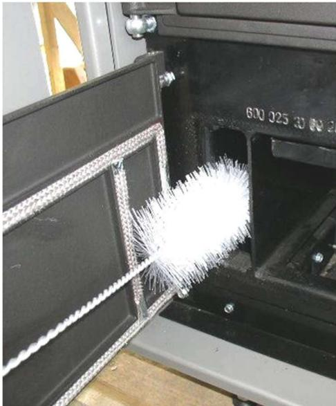
Abb. 138: Reinigung Heizgaszüge unten
