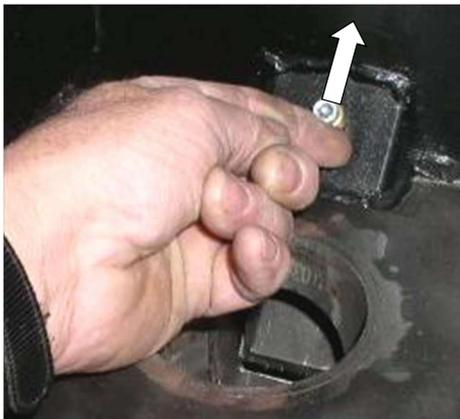
Abb. 113: Repetierhebel nach oben drücken!
