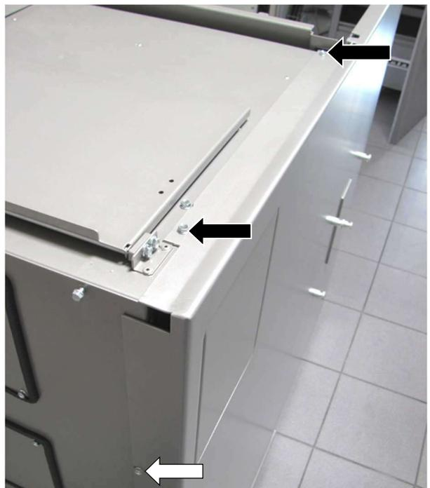
Abb. 16: Demontage Seitenverkleidung ivo.safe®
