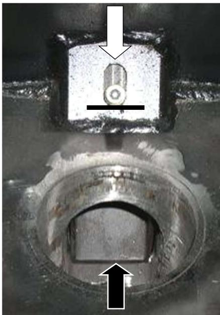
Abb. 119: Korrekte Position Brennertopf
