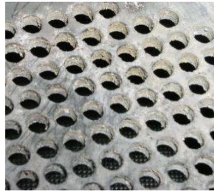
Abb. 124: Schwenkrost richtig gereinigt
