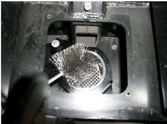
Abb. 122: Schwenkrost reinigen
