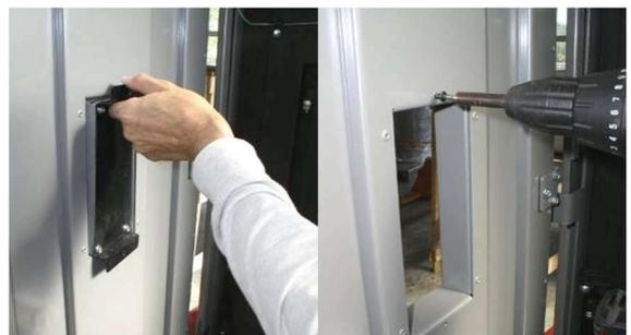
Abb. 25: Demontage / Montage Sichtblende
