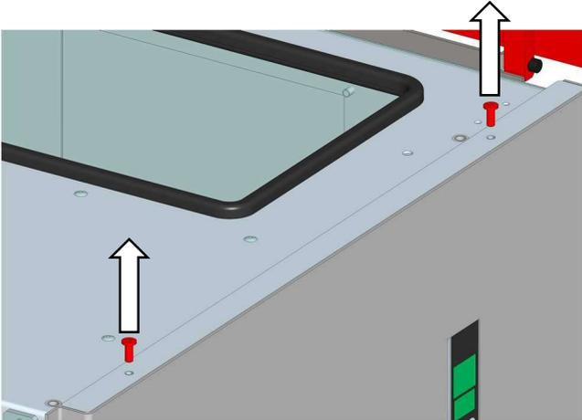
Abb. 21: Lösen Schrauben bei Seitenverkleidung
