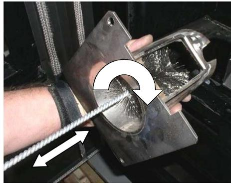
Abb. 115: Reinigung des Brennerkopfes
