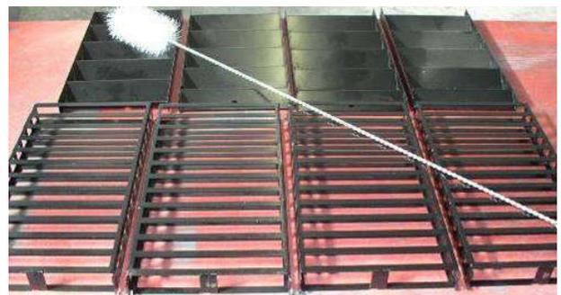
Abb. 141: Turbulatoren und WT- Rechen
