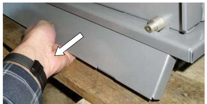
Abb. 3: Entfernen Sockelblenden
