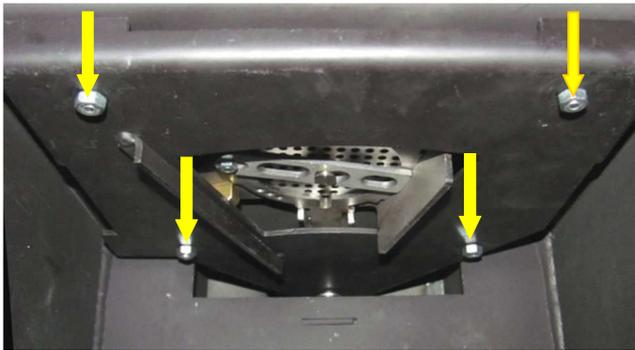
Abb. 127: Verschraubungen Schwenkrost
