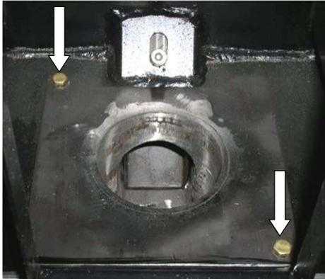
Abb. 112: Verschraubungen Brennerkopf
