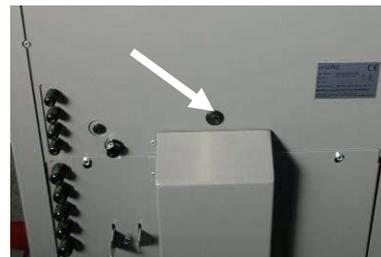
Abb. 62: Einbauöffnung mit Blindstopfen
