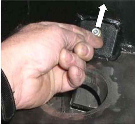
Abb. 118: Repetierhebel nach oben drücken!
