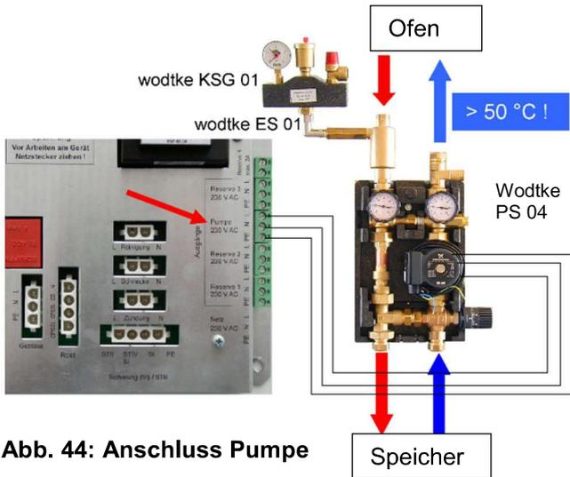
Abb. 44: Anschluss Pumpe
