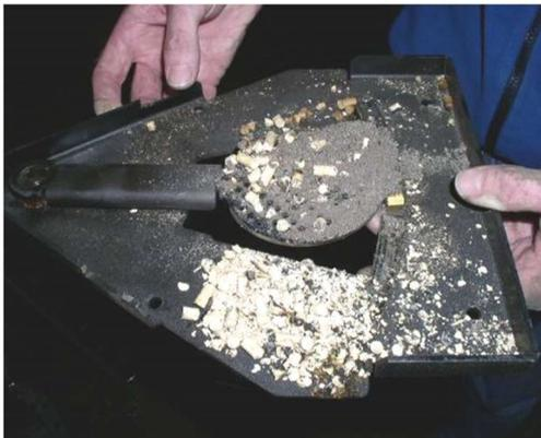
Abb. 128: Schwenkrost vom Träger entfernen
