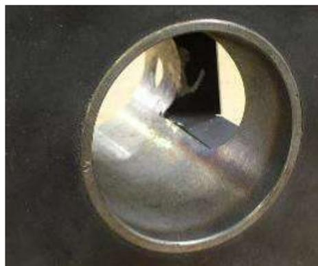
Abb. 117: Gereinigter Brennerkopf
