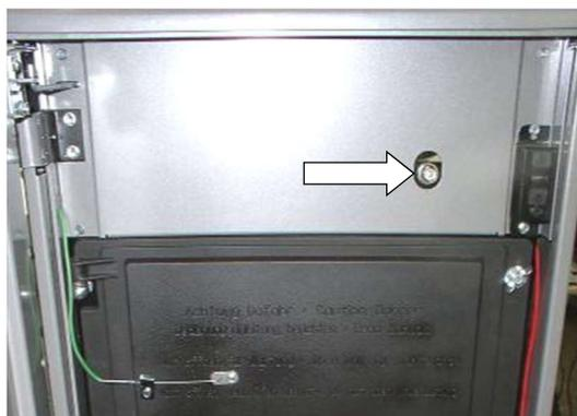
Abb. 45: Position Entlüftungsventil
