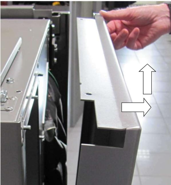
Abb. 17: Demontage Seitenverkleidung ivo.safe®
