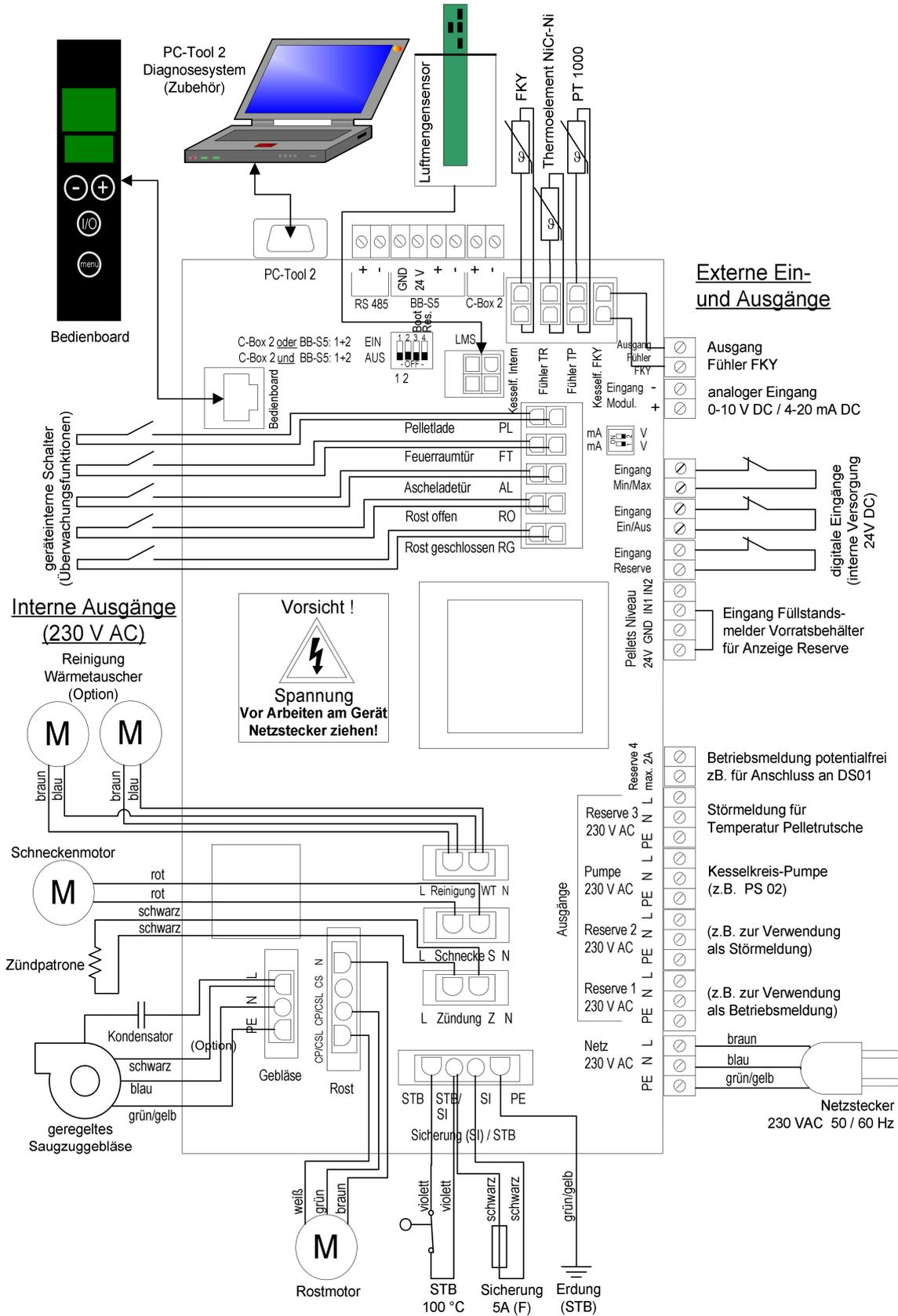
Abb. 49: Verdrahtungsplan Hauptplatine
