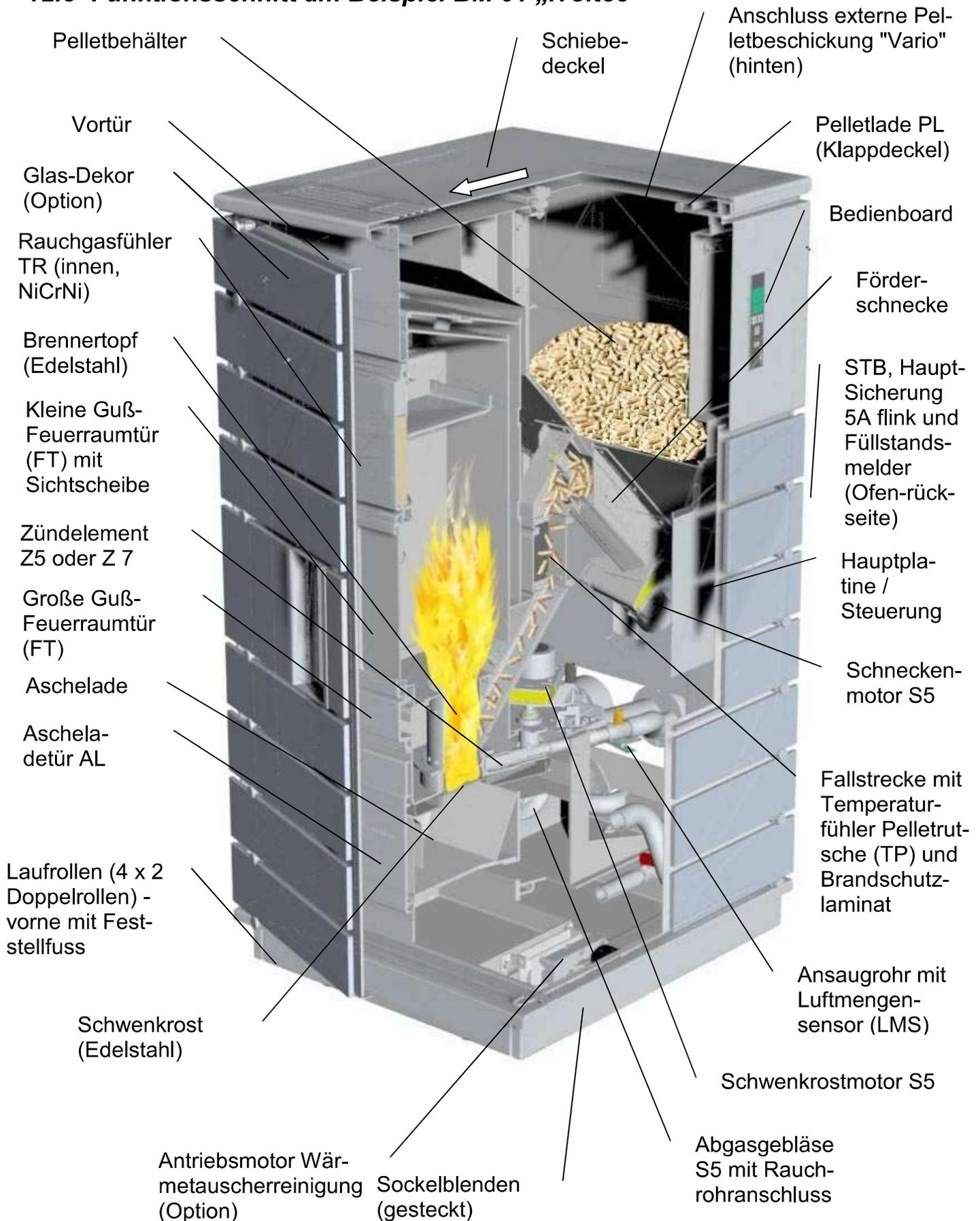
Abb. 82: Funktionsschnitt
