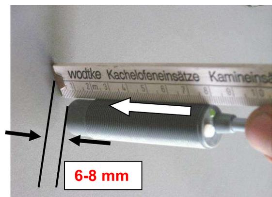
Abb. 67: Überprüfung Füllstandsmelder
