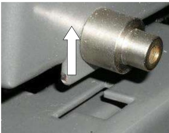
Abb. 14: Detail Führungszapfen
