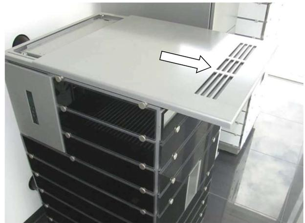
Abb. 86: Gerätedeckel BM01 „ivo.tec“ verschieben
