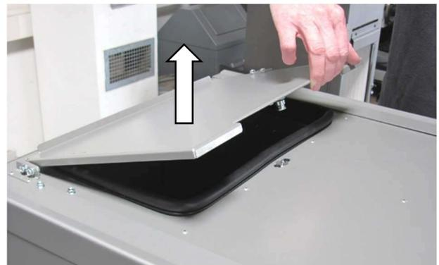
Abb. 87 Öffnen Pelletbehälter BM01-2 ivo.safe
