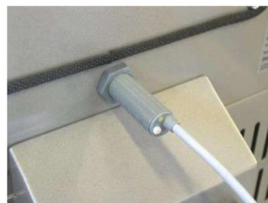
Abb. 63: Eingebauter Füllstandsmelder
