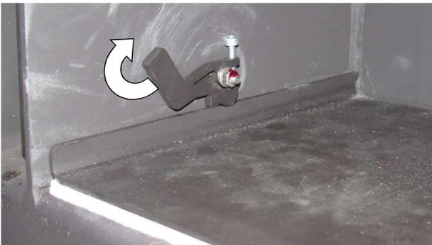
Abb. 106: Arretierung Abdeckplatte geschlossen
