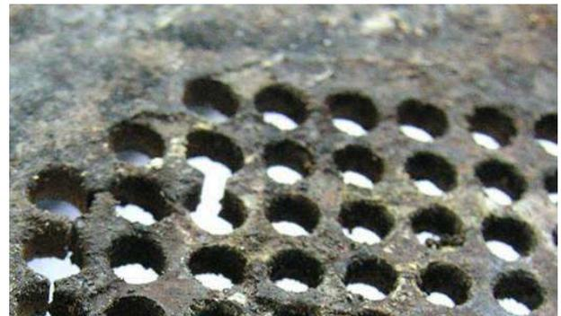
Abb. 126: Schwenkrost gerissen
