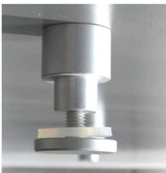
Abb. 39: Eingeschraubte Klemmschraube
