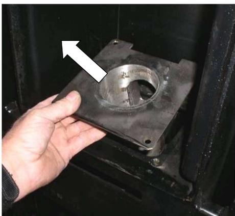
Abb. 114: Entnahme Brennerkopf
