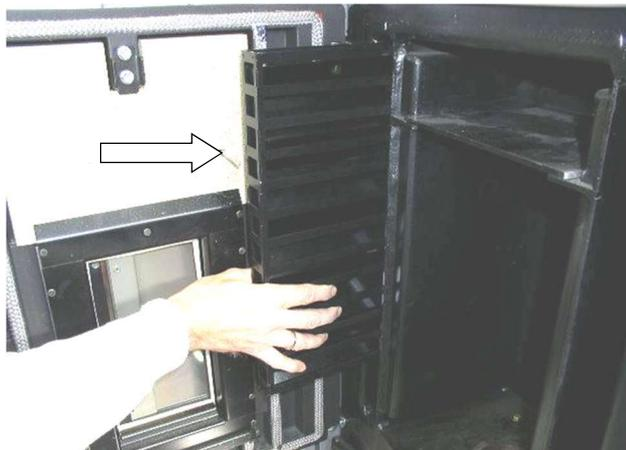
Abb. 133: Position TR-Fühler
