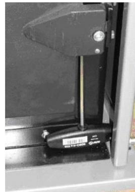
Abb. 81: Steckschlüssel Anlieferungszustand
