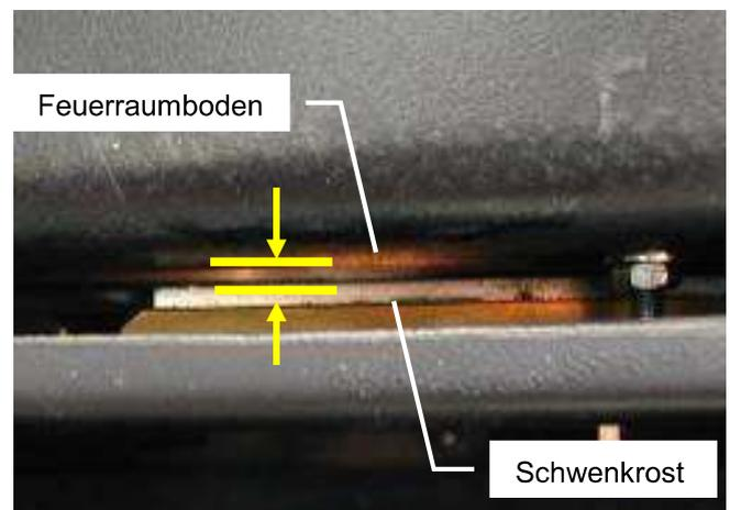
Abb. 104: Kontrollöffnung Schwenkrost
