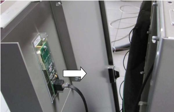
Abb. 22: Entfernen Bedienboardkabel
