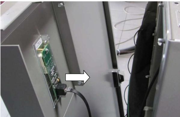
Abb. 18: Entfernen Bedienboardkabel
