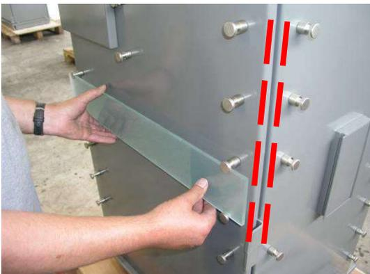
Abb. 33: Ausrichten Dekorglas
