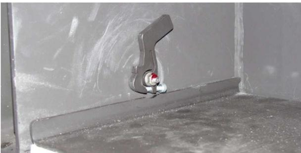
Abb. 107: Arretierung Abdeckung geöffnet
