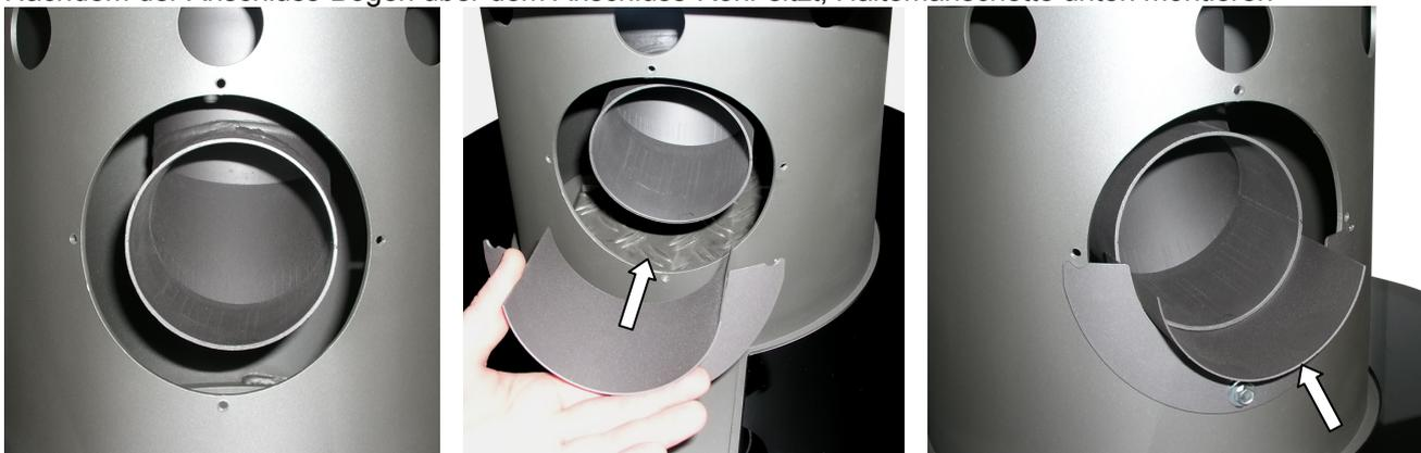
Jetzt die gewünschte Verbrennungsluftleitung (gewünschte wodtke Ø 100mm Rohre - nicht im Lieferumfang enthalten) in die untere Haltemanschette einlegen und über den Anschluss-Bogen schieben.
