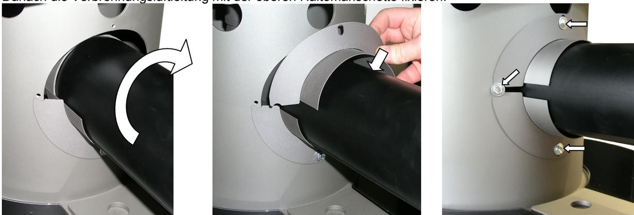
5. Ofen auf Drehbarkeit prüfen und Verbindungsleitung an allen Stellen auf Dichtheit prüfen. An Stellen an denen keine Dichtung vorhanden ist, müssen die Verbindungsstellen zusätzlich abgedichtet werden. Bedarfsgerechte und fachmännische Isolierung gegen Schwitzwasser durchführen.
