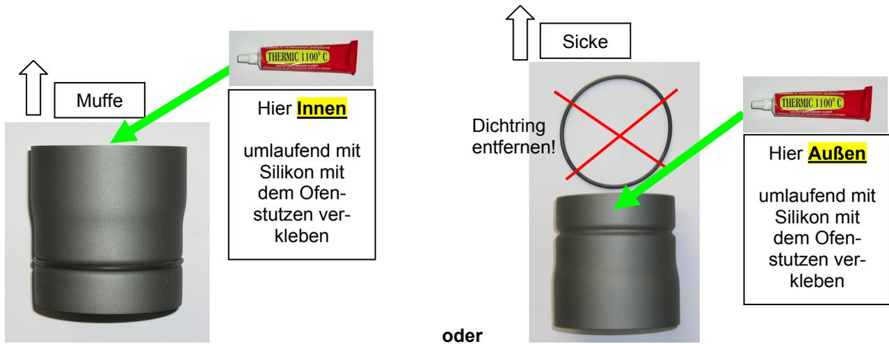
Das Anschluss-Rohr soll nach der Montage fest mit dem Ofenstutzen verbunden sein.
