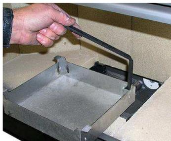
Abb. 24: Entnahme Aschelade
