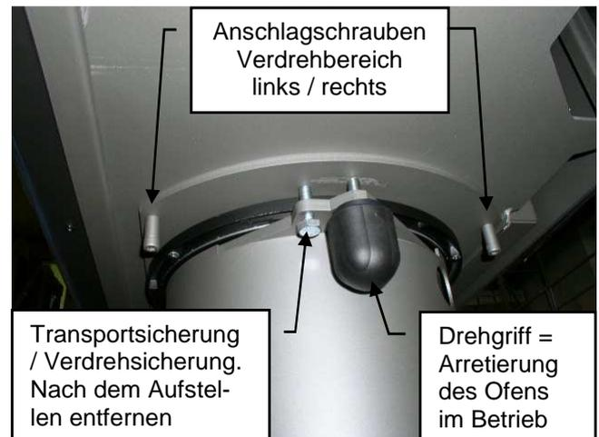
Abb. 7: Sicherungsschraube
