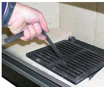
Abb. 23: Entnahme Rost
