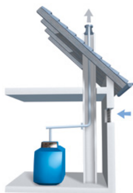
Raumluftabhängige Aufstellvariante mit eingezogenem Abgasrohr im Schornstein.
