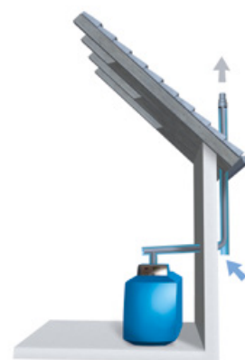
Raumluftunabhängige Aufstellvariante mit Rohr-in-Rohr-Kunststoff-Abgassystem entlang der Außenfassade.
