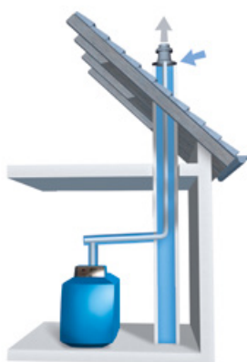
Raumluftunabhängige Aufstellvariante mit eingezogener Kunststoff-Abgasleitung im Schornstein.
