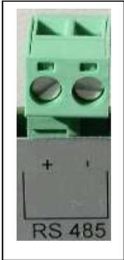
RS 485 - BUS-Eingang zum Ein-/Ausschalten und zur Modulation der Ofenleistung über einen externen, mit passender Bus-Kommunikation ausgestatteten Heizungsregler (Zubehör). Der Eingang „Bus“ muss zur Verwendung vorher aktiv geschaltet werden.
