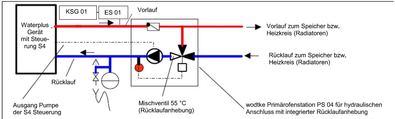
**Beispiel für den hydraulischen Anschluss des Waterplus-Gerätes an den Heizkreis (Ausführungsbeispiele ohne Anspruch auf Vollständigkeit). Sicherheitseinrichtungen teils nicht eingezeichnet. Die Beispiele ersetzen keine fachgerechte Planung und Ausführung.**
