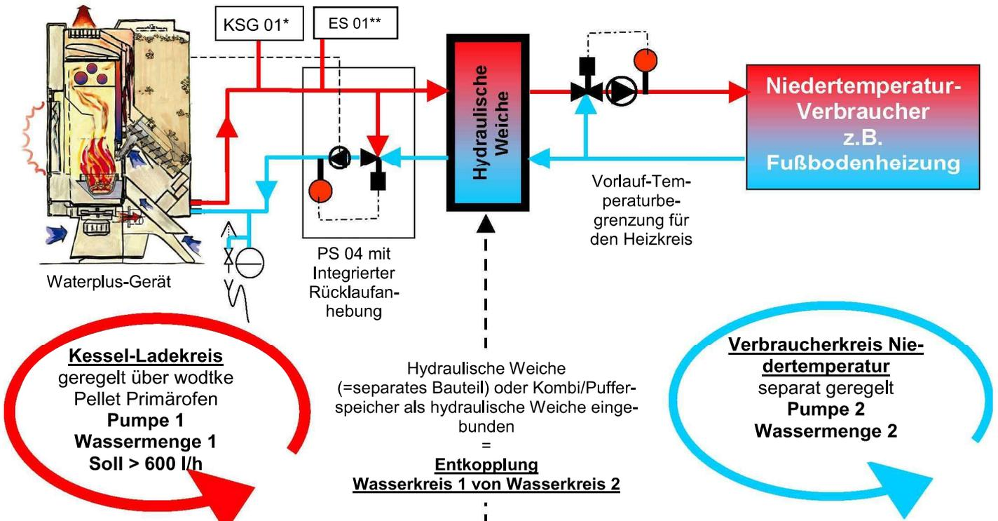
Beispiel für den hydraulischen Anschluss des Waterplus-Gerätes an den Heizkreis (Ausführungsbeispiele ohne Anspruch auf Vollständigkeit). Sicherheitseinrichtungen teils nicht eingezeichnet! Die Beispiele ersetzen keine fachgerechte Planung und Ausführung.
