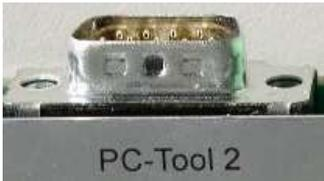
RS 232-Schnittstelle mit 9-poliger SUB-D-Kupplung: zum Anschluss des wotdke Diagnosesystems PC-Tool 2 (nur für Fachbetriebe). Auch zur Bus-Kommunikation mit von wotdke freigegebenen Heizungsreglern verwendbar (in Vorbereitung).
