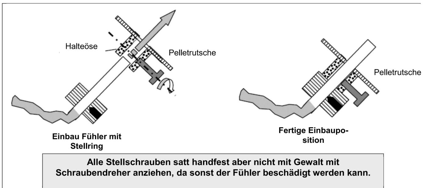
Nach dem Ausbau des defekten Fühlers den Stellingring des alten Fühlers demontieren, über den neuen Fühler schieben und exakt positionieren (**22 mm von der Fühlerspitze aus gemessen**).
