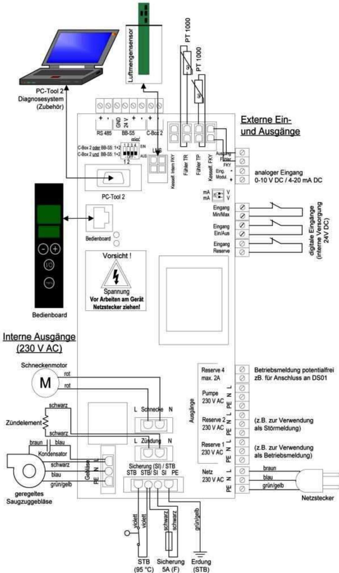
Verdrahtungsplan und Anschlussschema an der Hauptplatine
