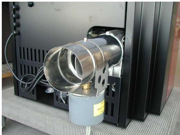
Wird die dicht schließende motorische Abgasklappe AK 1 von wotdke verwendet, dann kann der Schließkontakt dieser Klappe auf den Eingang Reserve gelegt werden. Der wotdke Pellet Primärofen geht dann nur in Betrieb, wenn die Abgasklappe geöffnet ist. Tritt an der Abgasklappe ein Fehler auf, so wird das Gerät über die Sicherheitsfunktion abgeschaltet.
