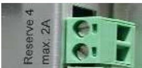
2-poliger, potentialfreier, zwangsgeführter und überwachter Relaisausgang (**Öffner**); max. 2 A belastbar: zum Anschluss externer Geräte, die bei Betrieb des Ofens ein potenzialfreies Öffnungssignal verlangen (z.B. wotke Differenzdruck-Controller DS01).
