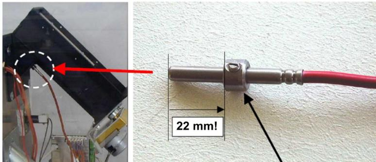
Stellingring exakt positionieren, da sonst Gefahr von Messfehlern besteht.
