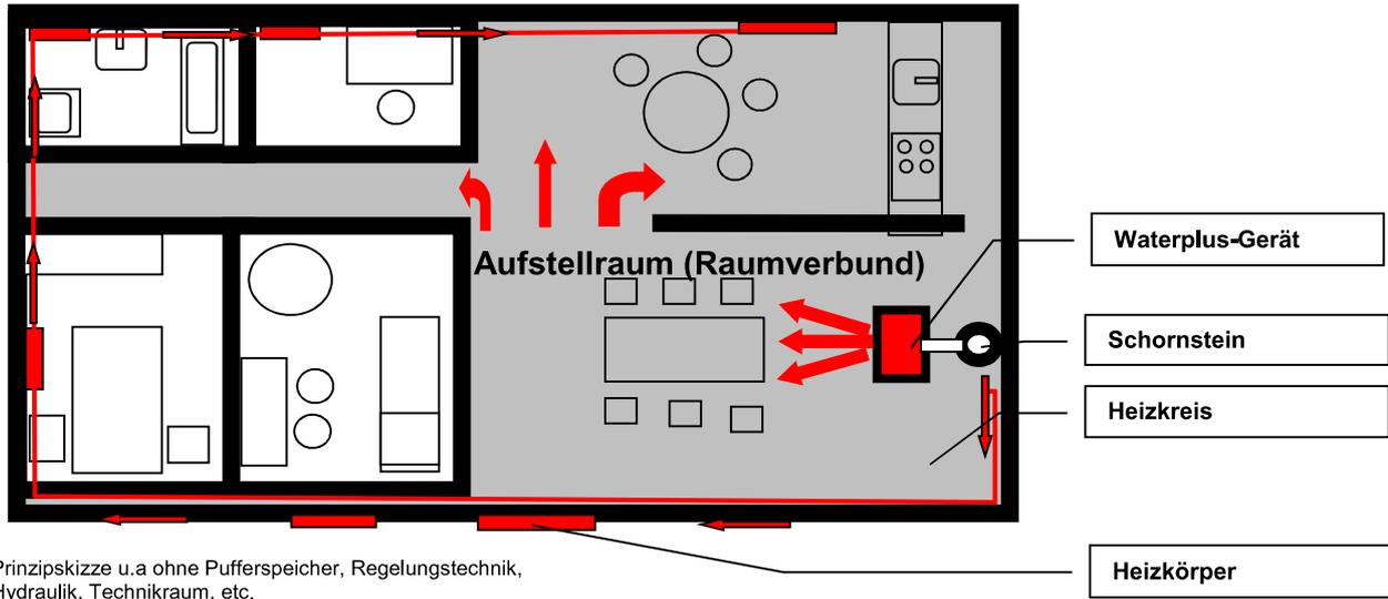
Ist der Aufstellraum zu klein bzw. ist der wasserseitige Leistungsbedarf zu groß, so führt dies zu einer Überhitzung des Aufstellraums.
