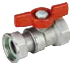
► Kugelhahn mit rotem Flügelgriff, **Wasserzähleranschlussverschraubung** und Innengewinde. Messing oder Messing verchromt. Für Heizung oder Trinkwasser. Verplombung möglich.
