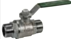
► Trinkwasser-Kugelhahn mit grünem Hebelgriff, Schwermodell mit AG/AG, Messing verchromt. Technische Daten wie R250W. DIN-DVGW geprüft, Registrier-Nr.: NW-6102BO0068 für Trinkwasser. **Flachdichtend.** Lieferbar in der Ausführung DIN-EN 13828 und DVGW W570-1.
