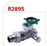
► Kugelhahn mit grünem Handrad, verzögerter Betätigung, lösbarer Verschraubung und Entleerung. Anschluss für Entleerung und Blindstopfen (als Montagesatz). Für Heizung oder Trinkwasser. Messing verchromt.
