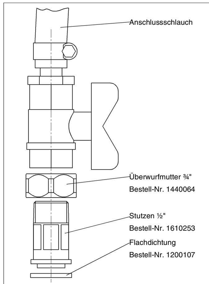
Abb. 2: Überwurfverschraubung installieren
