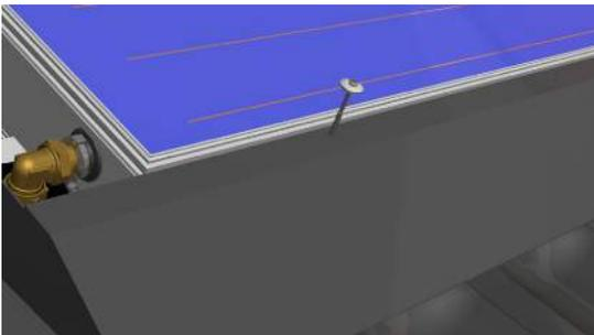
Nachdem das linke Traufblech eingehangen und ausgerichtet wurde, wird es nun mit den drei beiliegenden Dichtschrauben 5x100 mm in der darunter liegenden Konstruktionslatte fixiert. Nutzen Sie zur Positionierung der Schrauben die vorgestanzten Löcher im Traufblech.
