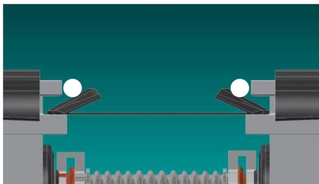
Anschließend wird das Zwischenblech in der Kollektornut verklebt, um es gegen Herausrutschen zu sichern. Der Silikonstreifen sollte eine Länge von 10 - 20 cm haben. Bitte beachten Sie, dass das Zwischenblech frei von Kleberesten sein muss, um das Abfließen von Regenwasser zu gewährleisten.
