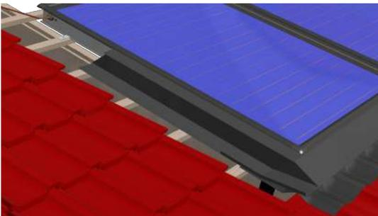
Beginnen Sie mit der Montage des unteren Seitenbleches. Schieben Sie dieses zuerst am unteren Ende beginnend unter das Gummiprofil in die Nut des Kollektorprofils und gleichzeitig in die jeweilige Traufblechecke hinein.
