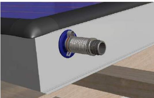
Führen Sie den hydraulischen Kollektorverbinder in das Sammelrohr ein. Achten Sie dabei darauf, dass beide Nullringe montiert sind. Schieben Sie den Verbinder bis zum Anschlag und fixieren Sie diesen mit der Sicherungsfeder.
