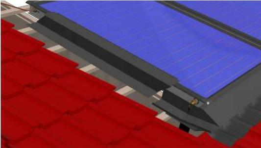
Im nächsten Schritt werden die Seitenbleche montiert. Diese sind so gefertigt, dass sie für die Montage auf der rechten oder linken Seite sowie als oberes und unteres Seitenblech unterschieden werden.
