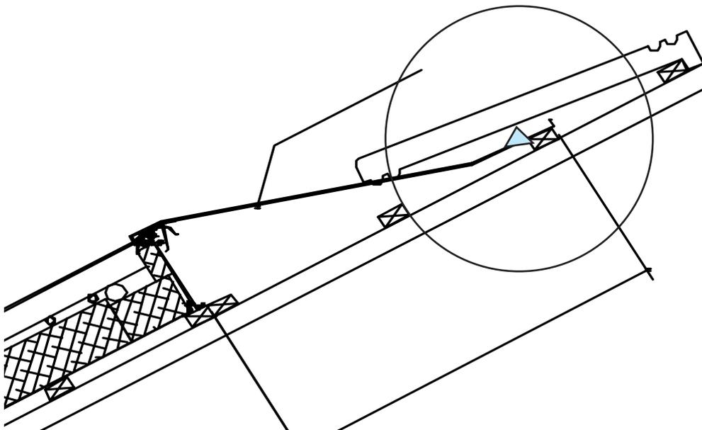
Auf dem Firstblech wird der Dichtkeil im vorderen Drittel unter dem Deckstein positioniert.
