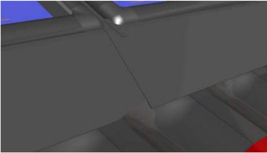
Die Trauflechterweiterung wird unter der Gummilippe eingeschoben und in die Nut des Kollektorprofils eingehangen.
