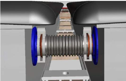
Sichern Sie nun die Kollektorverbinder am nächsten Kollektor ebenfalls mit Sicherungsfedern.
