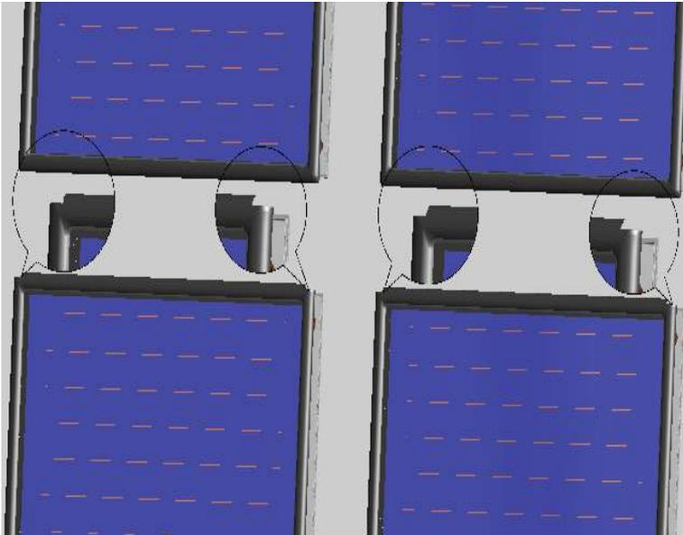
Durch das Entfernen der Lippe (Gummiabdichtung) an der vorgesehenen Stelle wird die spätere Montage der Zwischen- und Seitenbleche ermöglicht.
