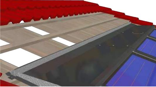
Abschließend werden auf den Seitenblechen der Einfassung die mitgelieferten Dichtkeile unmittelbar neben dem Wasserfalz aufgeklebt. Beim Aufbringen ist darauf zu achten, dass der Untergrund (Blech) trocken, staub- und schmutzfrei ist!
