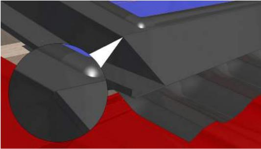
Achten Sie darauf, dass das Seitenblech bündig mit der Bugkante des Traufblechs abschließt und über die gesamte Länge in der entsprechenden Nut im Kollektorprofil unter der Gummilippe zum Liegen kommt.
