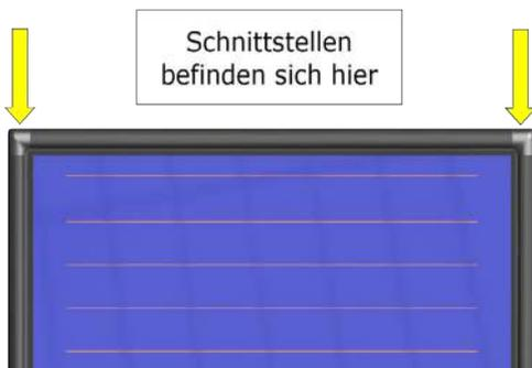
Um das Zwischenblech ordnungsgemäß zu montieren, werden am jeweils unteren Kollektor die vorgearbeiteten Schnittstellen der Lippe (Gummiabdichtung) ausgeschnitten. Dabei ist zu beachten, dass nur die horizontal liegenden Schnittstellen ausgeschnitten werden. Schnittstellen werden nur an den Stellen bearbeitet, an denen ein Zwischenblech und Seitenblech montiert wird. Die Bearbeitung an der Außenseite des Kollektorfeldes ist ebenfalls notwendig.
