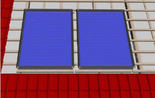
Nach dem Auflegen des ersten Kollektors wird der folgende Kollektor mit einem Abstand von 10 bis 20 cm neben dem ersten Kollektor platziert.
