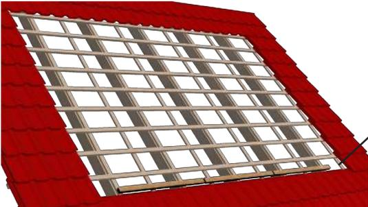
Abgedeckte Dachfläche mit Konstruktionslatten.
