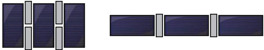
Bei den Kollektortypen FKA 200 V, FKA 240 V und FKA 270 V werden zwischen jedem Kollektorübergang zwei Zwischenbleche montiert. Für die Kollektoren FKA 200 H, FKA 240 H und 270 H ist die Montage eines Zwischenbleches vorgesehen. Bei der Montage mehrreihiger Anlagen werden die Zwischenbleche, wie anbei beschrieben, montiert. Die Zwischenbleche können von oben oder unten montiert werden.
