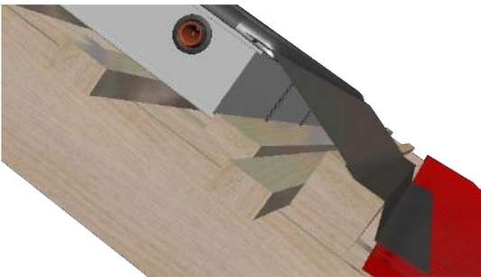
Erfolgt die Montage der Kollektoren auf Dächern mit flachaufbauender Dacheindeckung, z.B. Schiefer, Schindel oder Prefa, kann zur Unterstützung des Traufblechs bauseitig unter dem Traufblech eine zusätzliche Latte angebracht werden.
