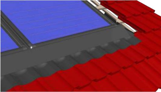
Je nach Kollektoranzahl müssen die nächsten Traufblecherweiterungen bzw. das Traufblech rechts montiert und fixiert werden.
