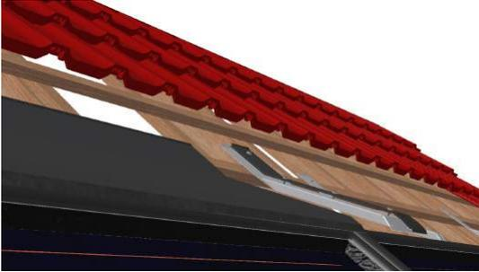
Schieben Sie nun den vormontierten Firstblechverbinder an das montierte Firstblech. Es ist das zwingend darauf zu achten, dass das Firstblech zwischen dem Ober- und dem Unterteil des Firstblechverbinders zum Liegen kommt.
