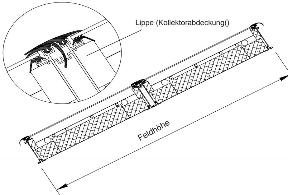
Bei mehrreihigen Anlagen werden die Kollektoren in den Reihen übereinander immer auf Stoß montiert. Dabei wird die Lippe (Kollektorabdeckung) des oberen Kollektors über den unteren Kollektor gelegt. Die Lippe (Kollektorabdeckung) des unteren Kollektors wird im Stoßbereich verklemt, so dass ein optimaler Wasserlauf gewährleistet ist.
