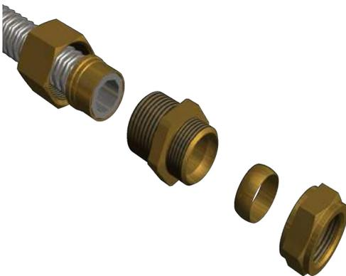
Im nächsten Schritt werden die Komponenten gemäß nebenstehender Zeichnung auf das Rohrende geschoben. Achten Sie dabei darauf, dass das Rohr durch den Stauchring bis zum Anschlag in den Fitting geschoben wird. Ziehen Sie nun die Überwurfmutter handfest an. Anschließend wird die Mutter mit 3 1/2 bis 4 Umdrehungen mit entsprechenden Schlüsseln festgezogen.
