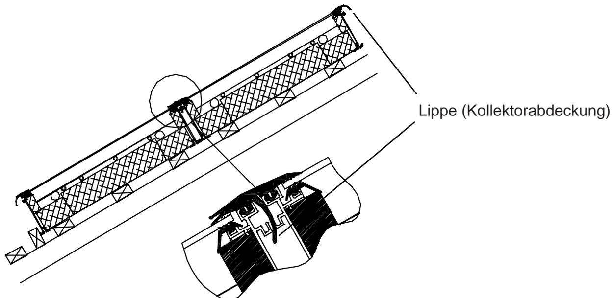
Bei mehrreihigen Anlagen werden die Kollektoren in den Reihen übereinander immer auf Stoß montiert. Dabei wird die Lippe (Gummiabdichtung) des oberen Kollektors über den unteren Kollektor gelegt. Die Lippe (Gummiabdichtung) des unteren Kollektors wird im Stoßbereich verklemmt, sodass ein optimaler Wasserlauf gewährleistet ist.
