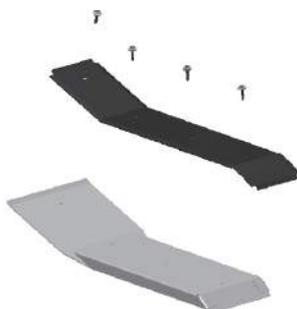
Montieren Sie die Abdeckung für den Firstblechverbinder vor, indem Sie die beiliegenden Dichtschrauben in die vorgestanzten Löcher einführen und vorsichtig anschrauben.
