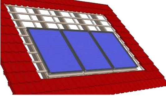
Die Montage des Blechsets erfolgt zwingend mit dem linken Traufblech, da die folgenden Traufbleche so konstruiert sind, dass sie von rechts aufgeschoben werden.
