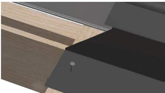
In der Überdeckung wird das Seitenblech gegen Herausrutschen mit Dachnägeln gesichert. Die gelieferten Hafter dienen zur zusätzlichen Sicherung. Die Hafter dürfen nicht im Bereich der Überdeckung des Seitenblechs montiert werden.
