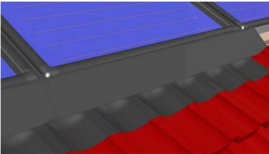
Das folgende Traufblech wird rechts unter die Gummilippe in die Nut des Kollektors eingehangen und anschließend nach links, in den Falz des bereits montierten Traufblechs eingeschoben.
