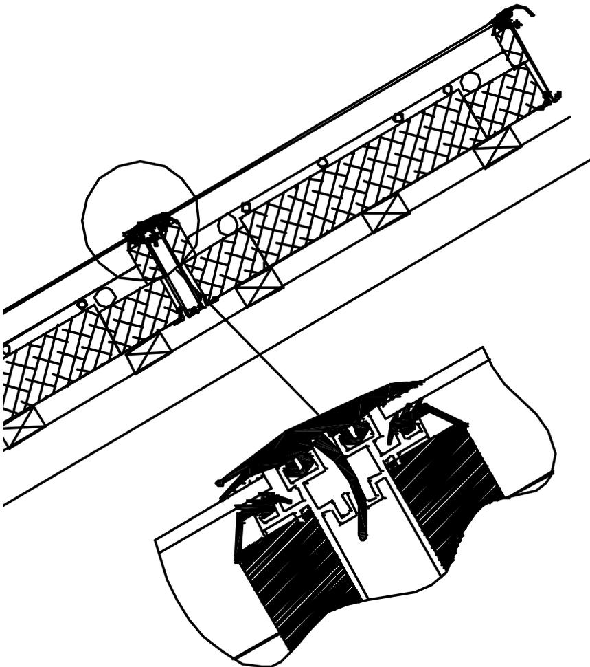
Bei Montage des oberen Kollektors ist darauf zu achten, dass der Kollektorrahmen des unteren Kollektors vom oberen Kollektor überdeckt wird.
