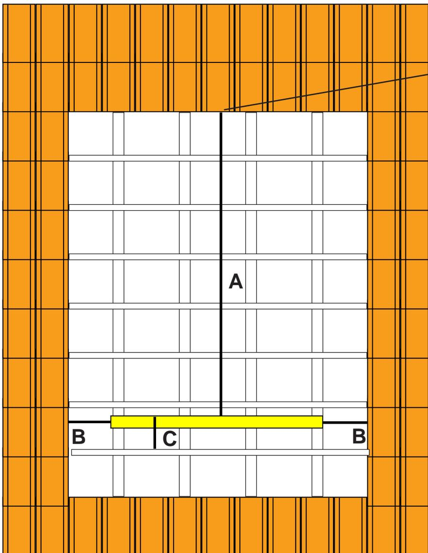
Um die obere Dachsteinreihe nicht bearbeiten/schneiden zu müssen, wird empfohlen, ausgehend vom Maß A, die oben liegende Dachsteinreihe ebenfalls abzudecken.
