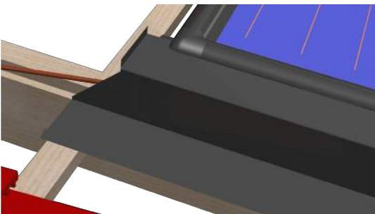
Das obere Seitenblech wird so ausgerichtet, dass der Falz bündig mit dem oberen Kollektorende am obersten Kollektor abschließt.
