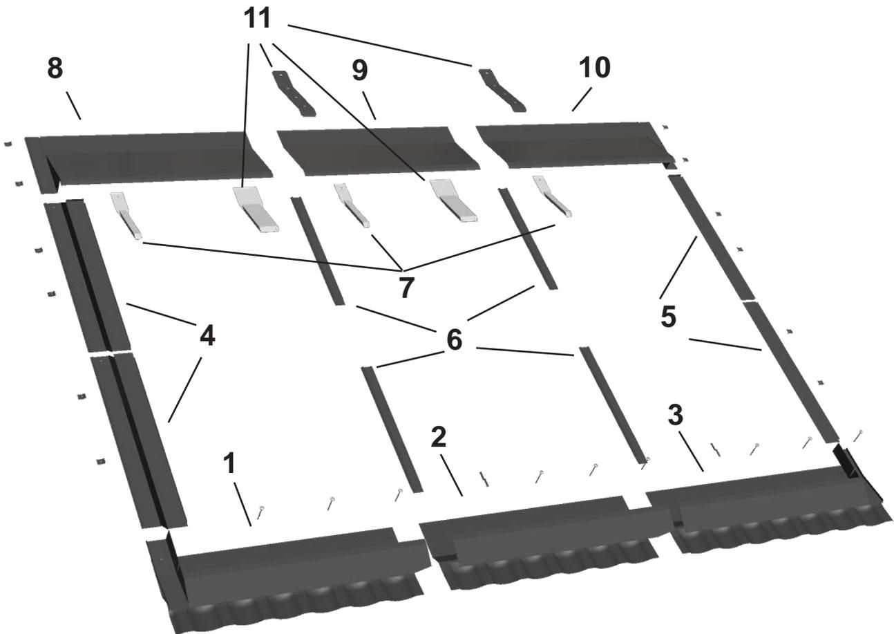
Im Bild dargestellt ist ein Blechset für die Montage von drei Kollektoren FKA 240 V in einer Reihe. Die Anzahl sowie die Bestandteile des Blechsets für Ihre spezifische Anlage können von der gezeigten Darstellung abweichen.
