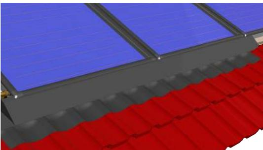
Nachdem die Trauflechterweiterung eingehangen und ausgerichtet wurde, wird es nun mit den drei beiliegenden Dichtschrauben 5x100 mm in der darunter liegenden Konstruktionslatte fixiert. Nutzen Sie zur Positionierung der Schrauben die vorgestanzt Löcher im Traufblech.
