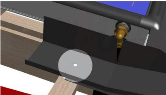
Fixieren Sie das Traufblech max. 8 cm vom oberen Abschluss mit einem Nagel im Bereich der Überdeckung des Seitenblechs. Sollte in diesem Bereich keine Latte zum liegen kommen, muss eine Zusatzlatte montiert werden.
