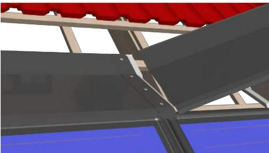
Schieben Sie nun das folgende Firstblech zwischen das Ober- und Unterteil des Firstblechverbinders ein.
