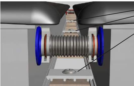
An der Innenseite (zwischen den Kollektoren) werden ebenfalls drei Befestigungsplatten montiert. Der Abstand zwischen den beiden Kollektoren wird durch die Befestigungsplatte vorgegeben.
