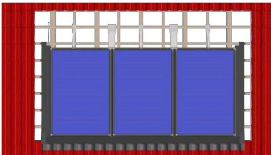
Bevor die Firstbleche montiert werden können, müssen die Versteifungsbleche in die Nut der Kollektorprofile eingehangen werden. Bringen Sie dazu nach den Maßen aus oben stehender Tabelle die jeweiligen Bauteile in Position.
