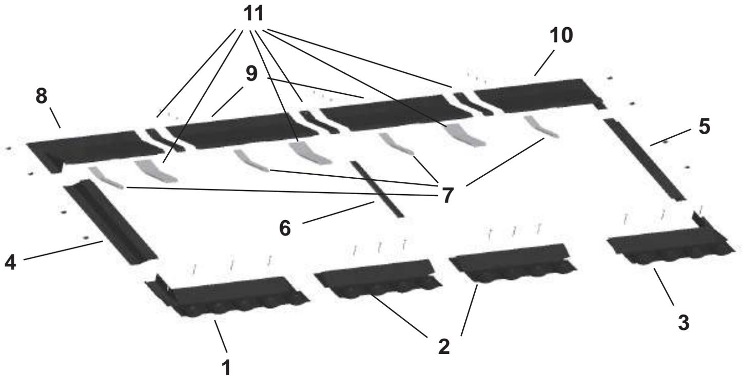
Im Bild dargestellt ist ein Blechset für die Montage von zwei Kollektoren FKA 240 H in einer Reihe. Die Anzahl sowie die Bestandteile des Blechsets für Ihre spezifische Anlage können von der gezeigten Darstellung abweichen.
