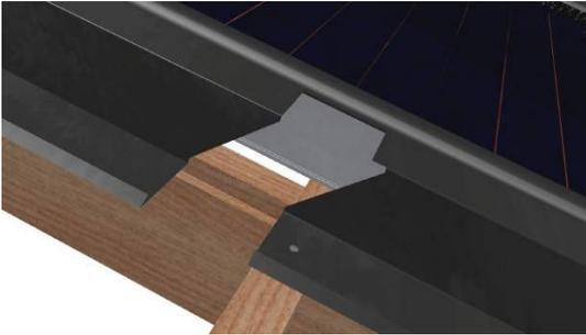
Anschließend wird das obere Seitenblech montiert. Achten Sie darauf, dass das Seitenblech über die gesamte Länge in der entsprechenden Nut im Kollektorprofil unter der Gummilippe zum Liegen kommt.
