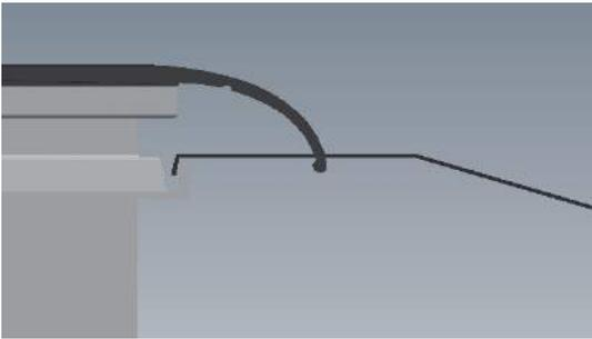
Das Traufblech wird links unter der Gummilippe eingeschoben und in die Nut des Kollektorprofils eingehangen. Schieben Sie das Traufblech nach links bis zum Kollektorrahmen, sodass ein 10cm Überstand für das Seitenblech entsteht.
