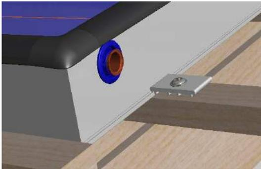
Nach dem Ausrichten des letzten Kollektors, wird dieser nun mit den äußeren Befestigungsplatten an drei Punkten fixiert.
