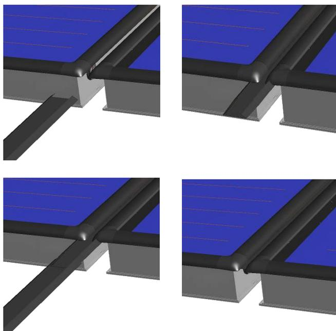
Das Zwischenblech wird von unten/oben in die Kollektornuten eingeführt. Bei vertikalen Kollektoren bzw. bei der mehrreihigen Montage der Kollektoren werden weitere Zwischenbleche von unten/oben nachgeschoben. Das Zwischenblech wird soweit eingeschoben, bis es unten bündig mit der Lippe (Gummiabdichtung) abschließt. Nach der Montage der Zwischenbleche wird die Lasche des Traufblechs auf das Zwischenblech umgelegt.
