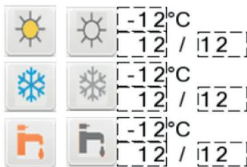
Für die Kaskadenregelung der Wärmepumpen werden hier die Symbole für die Betriebsarten „Heizen“ (**Sonne** [☀]), „Kühlen“ (**Schneeflocke** [❄]) und „WW-Speicher“ (**Wasserhahn** [🚰]) angezeigt.
