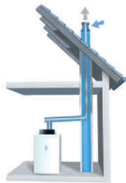
Raumluftunabhängige Aufstellvariante mit konzentrischem Luft-Abgas-System aus Kunststoff im Schornstein oder Schacht.
