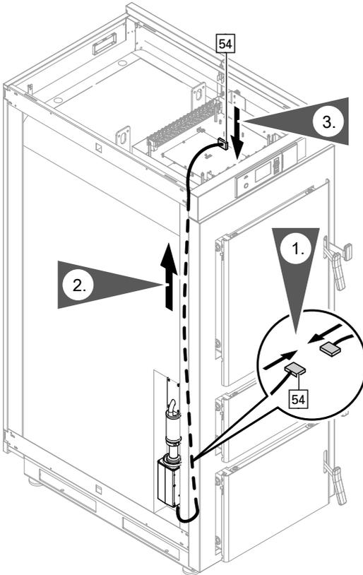
1. Elektrische Leitung zur Regelung verlegen und mit Leitungsbindern sichern.
