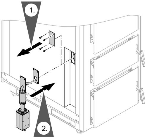
1. Blech abschrauben und die Dichtfläche von Dichtmasseresten reinigen.
