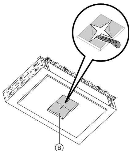
2. Wind-/Dampfsperre (B) kreuzförmig aufschneiden. Falls erforderlich mitig einen kleinen Abschnitt entfernen.
