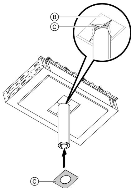
4. Mitgelieferte Dichtmanschette (C) bis über die Wind-/Dampfsperre (B) auf das Abgasrohr schieben.
