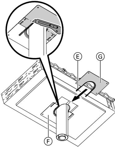
7. 2. Hälfte des Dichtprofils (E) auf die obere Hälfte der Abdeckblende (G) aufstecken.
