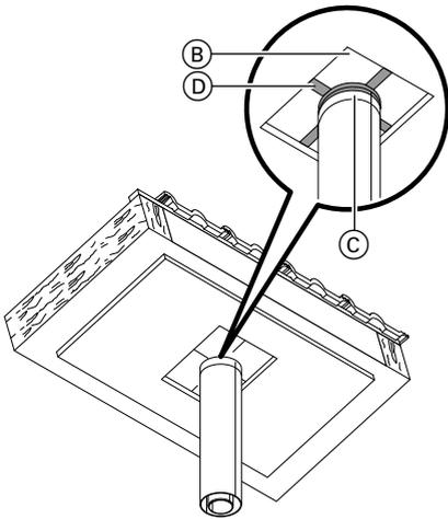
5. Wind-/Dampfsperre (B) mit den mitgelieferten Klebandstreifen (D) an die Dichtmanschette (C) kleben.
