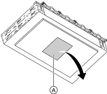
1. Öffnung (A) in Gipskartonplatte scheiden. Ggf. Gipskartonplatte abnehmen.
