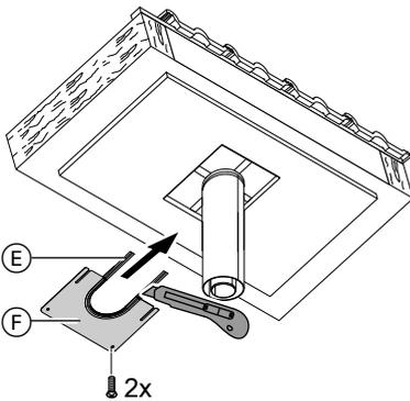
6. Eine Hälfte des Dichtprofils (E) auf die Abdeckblende mit Langloch (F) aufstecken. Dichtprofil (E) an der Kante der Abdeckblende (F) abschneiden und die Abdeckblende anschrauben.
