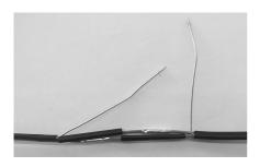
2 Schrumpfschläuche (Länge 45 mm) aufschieben. Stoßverbinder (1,0 mm²) mit Crimpzange auf Adern der anderen Anschlussleitung aufquetschen.
