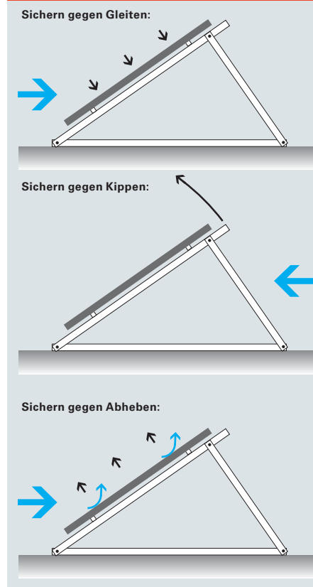
Abb. 6 Sichern der Sonnenkollektoren
