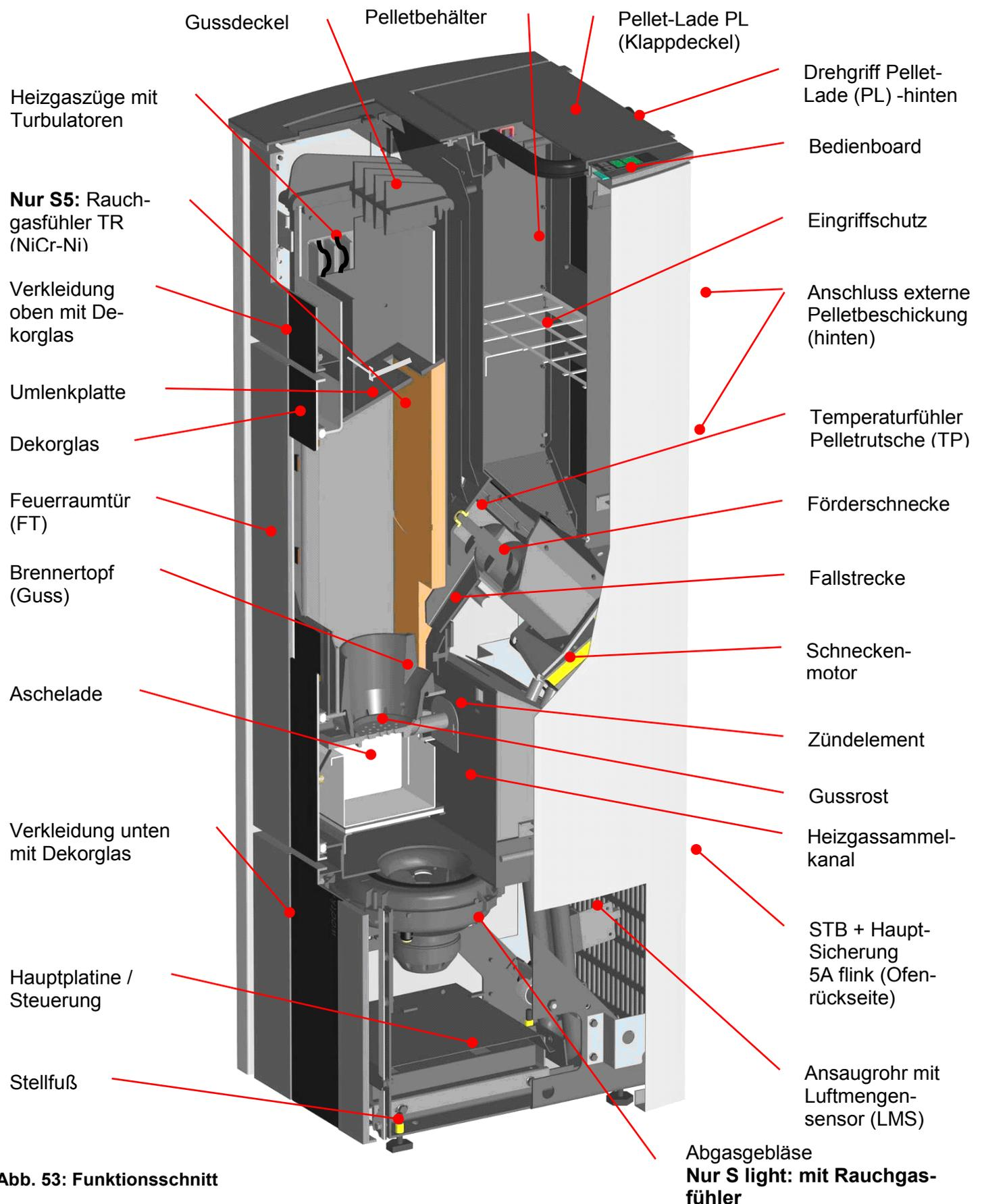
Abb. 53: Funktionsschnitt
