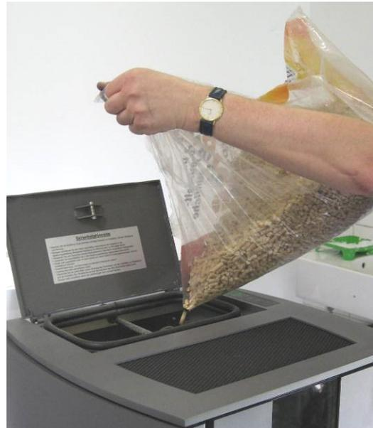
Abb. 59: Nachfüllen der Pellets
