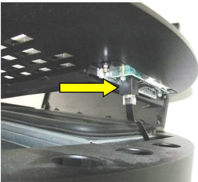
Abb. 12: Kabelverbindung Bedienboard
