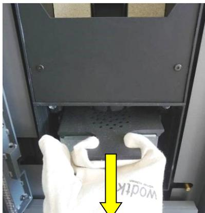
Abb. 69: Gussrost entfernen
