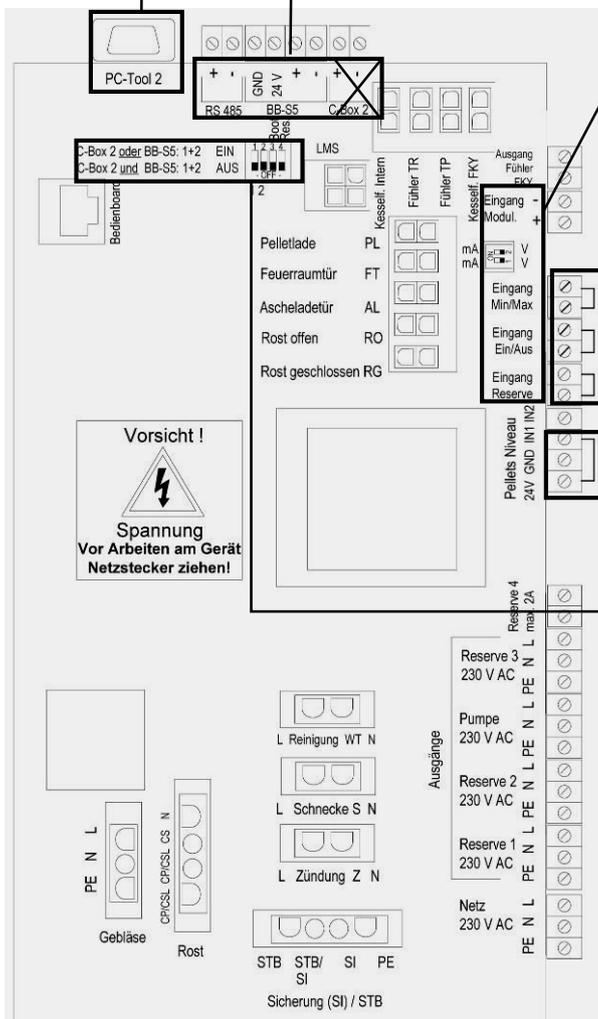
Wird ein Eingang durch einen externen Regler/Fühler belegt, so muss der zugehörige Brückendraht vorher entfernt werden! Sind keine externen Regler angeschlossen, müssen alle 3 Brückendrahte wie dargestellt vorhanden sein. Sonst reagiert der Ofen nicht ordnungsgemäß!
