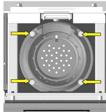
**Abb. 77: Verschraubungen Brennertopf**
