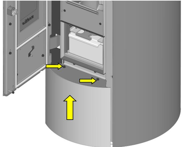
Abb. 14: Verkleidung unten demontieren
