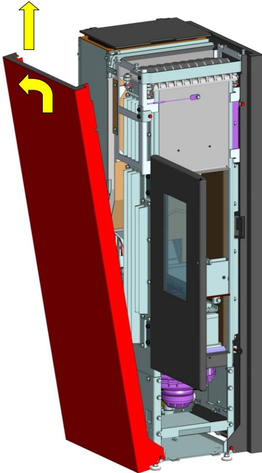
Abb. 26: Seitenverkleidung demontieren
