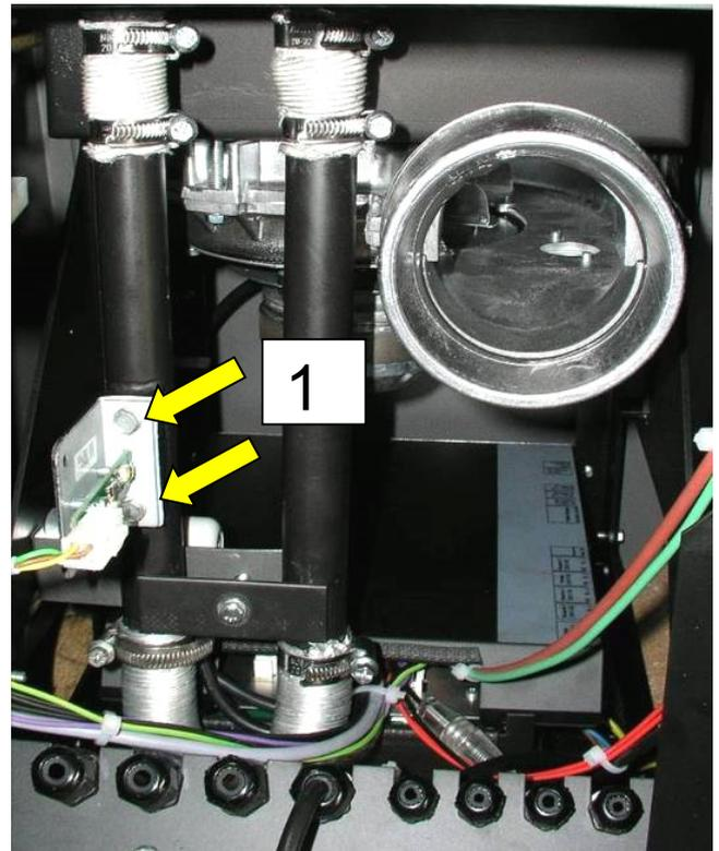
Abb. 94: Verschraubungen Luftmengensensor
