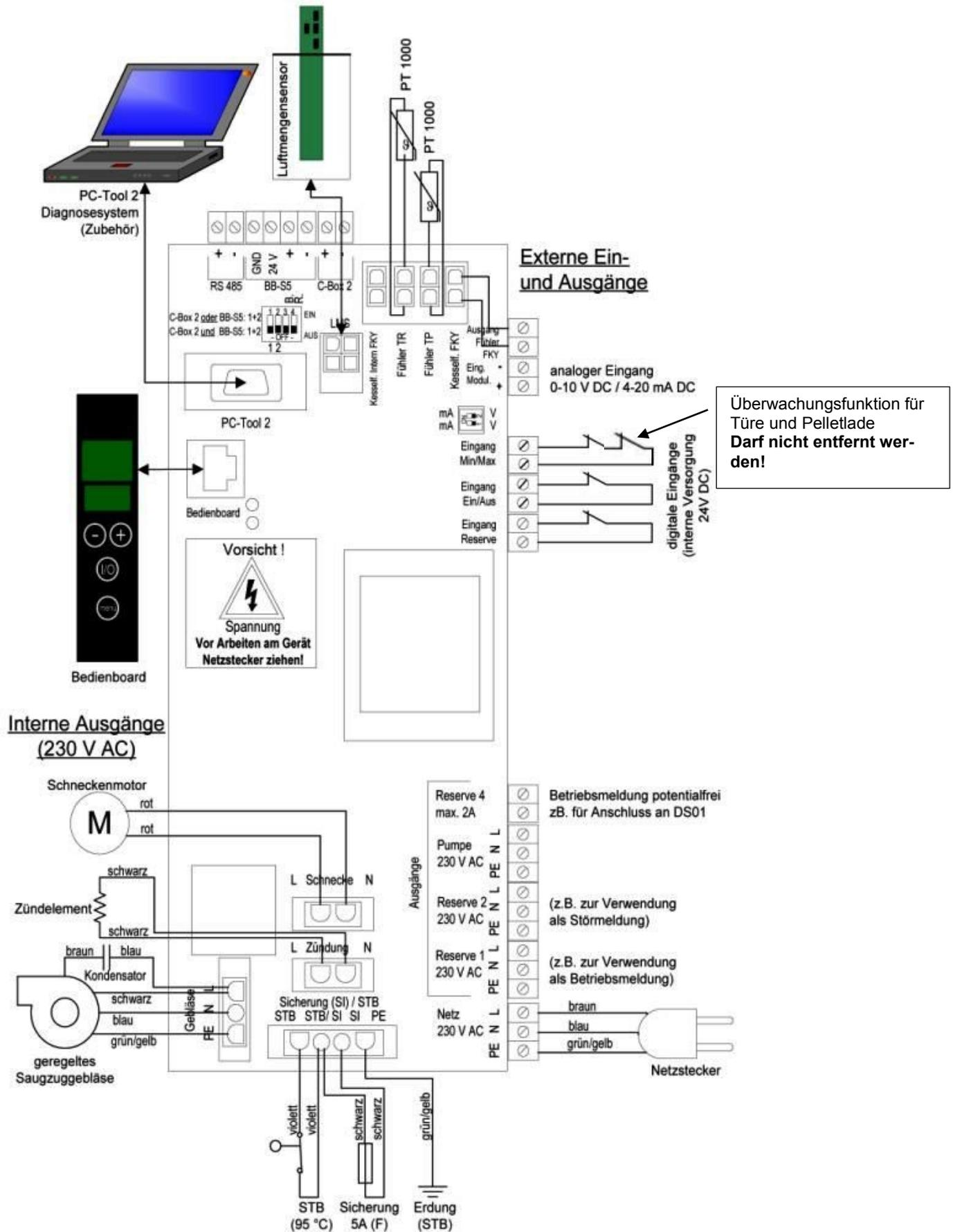
Abb. 33: Schaltplan PO 03 „S light“ Baureihe
