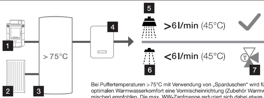
Bei Puffertemperaturen >75°C mit Verwendung von „Sparduschen“ wird für einen optimalen Warmwasserkomfort eine Vormischeinrichtung (Zubehör Warmwassermischer) empfohlen. Die max. WW-Zapfmenge reduziert sich dabei etwas.
